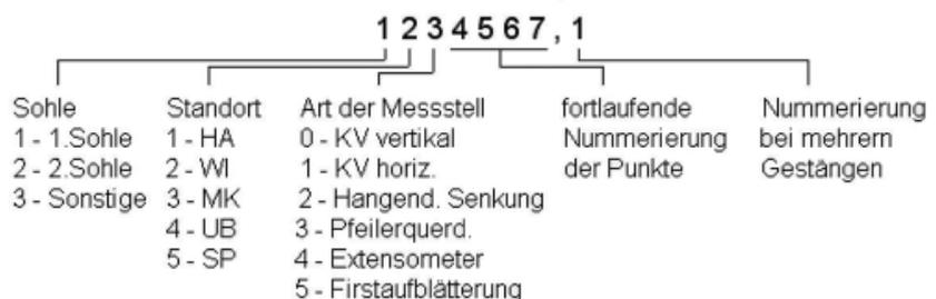
Abb. 4: Aufbau der neuen Messpunkt-Kodierung
