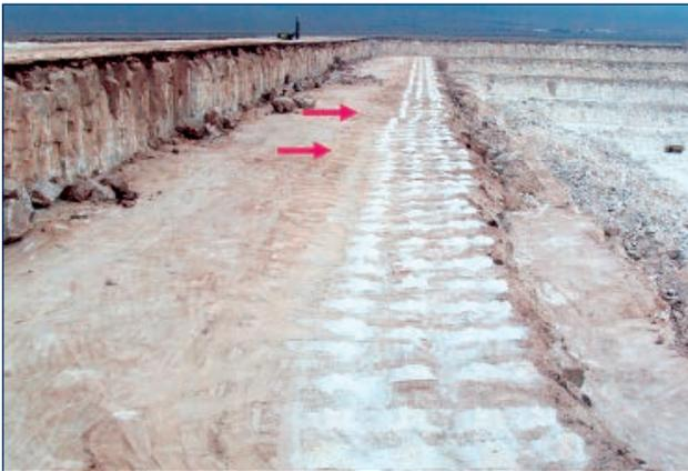
Abb. 17: Sprengarbeiten mit Testfeldern im Tagebau Loberas
