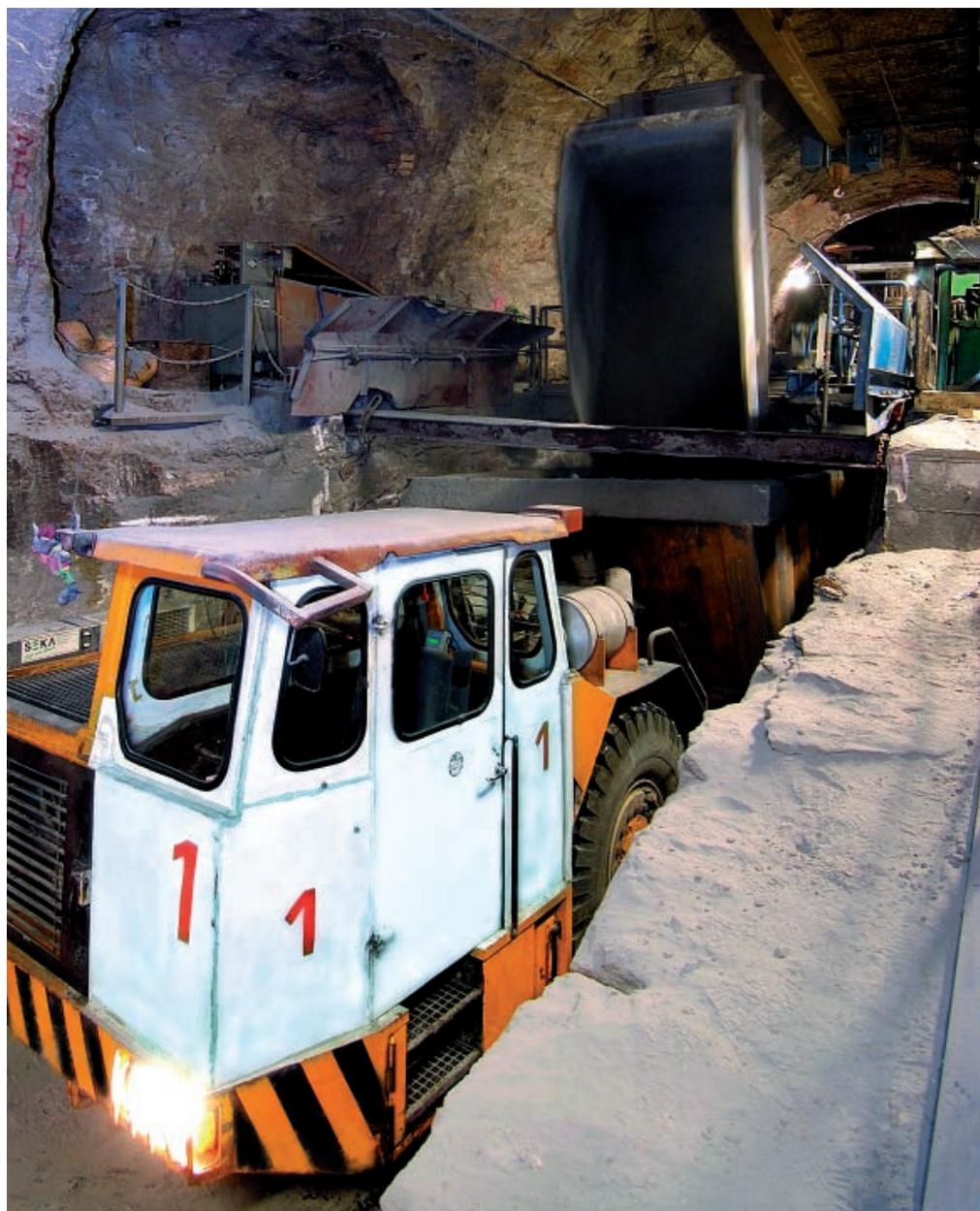
Schüttgutversatz: Umschlag untertage – muldengestütztes Transportsystem in Muldenkipper
