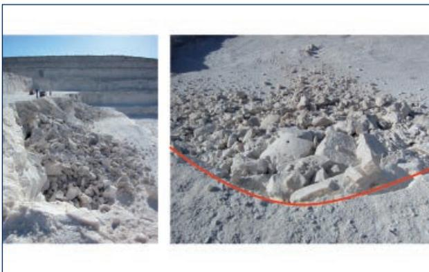
Abb. 13: Ermittlung der Grenzvorgaben mit Sprengung von einzelnen Löchern, Sprengtrog
