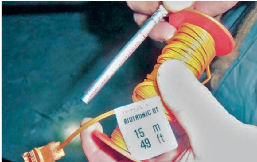
Abb. 6: Elektronischer Zünder des Typs RIOTRONIC DT
