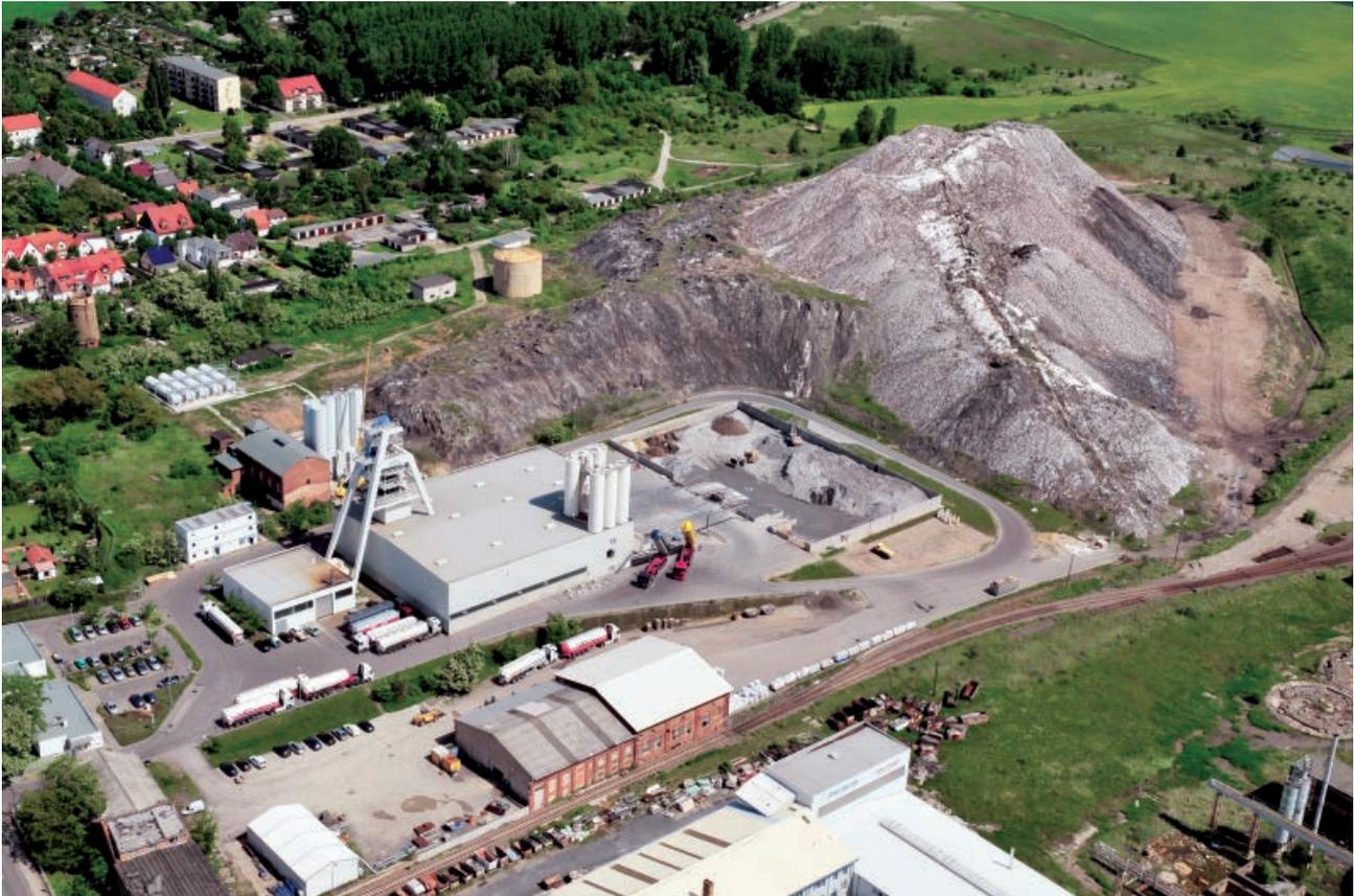
Schachtförderanlage, Dickstoffanlage, Freilagerfläche und Schachthalle mit Homogenisierungsanlage, Osthalde
