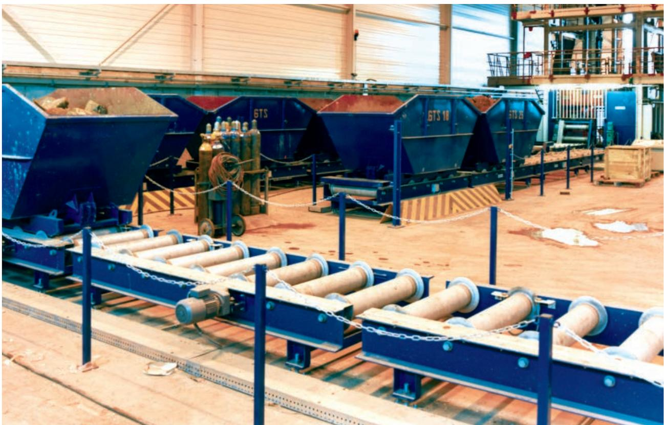
Schüttgutversatz: Am Schacht bereitgestellte mulden-gestützte Transporte mit Schüttgut
