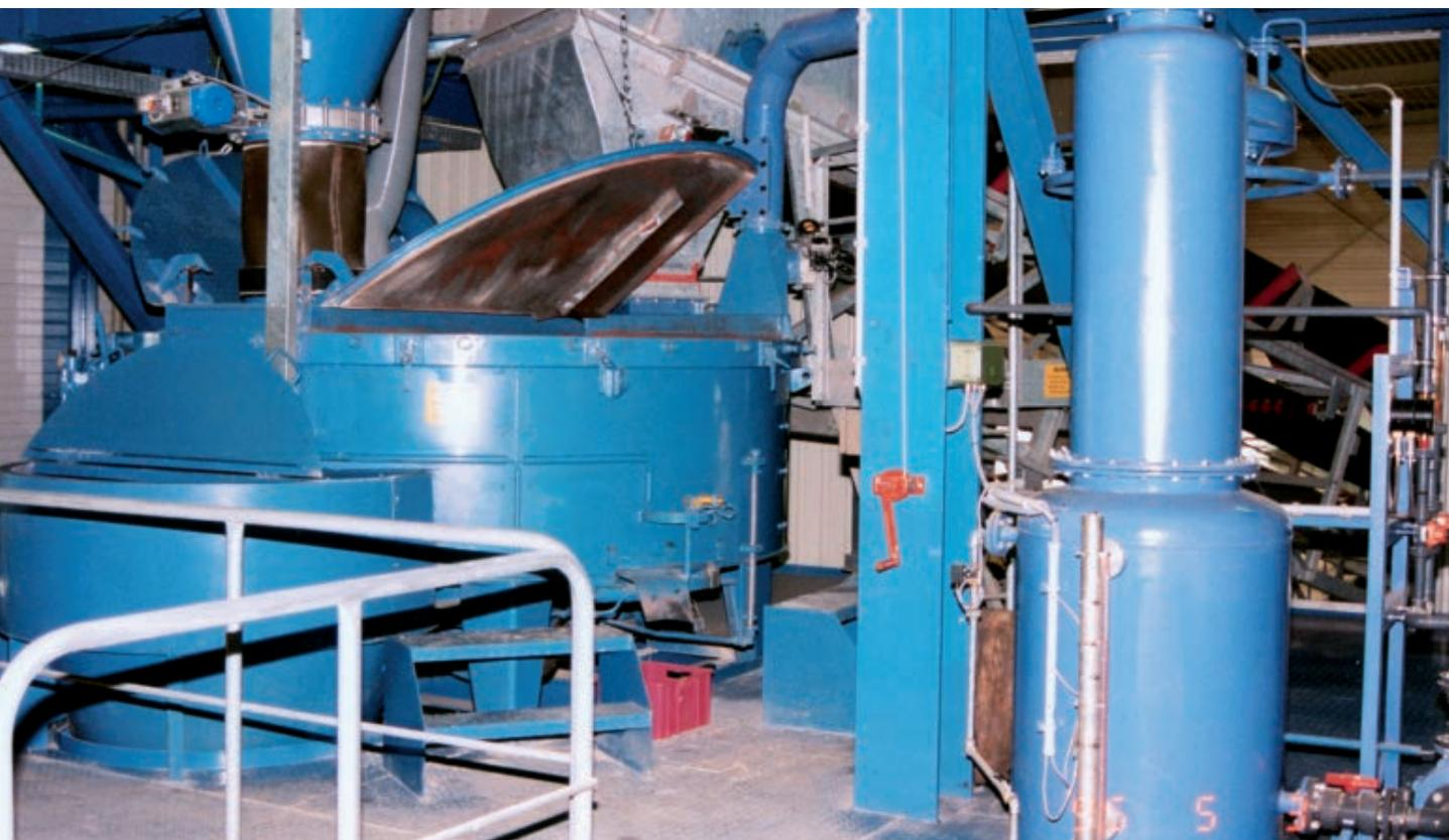
Homogenisierungsanlage zur Herstellung von Versatzmischungen in Schüttgutqualität
