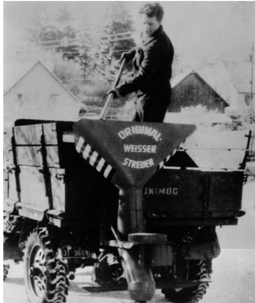
Abb. 1: Eines der ersten Streugeräte mit Streuteller der Firma Weisser, der Streuer wurde manuell von oben während des Fahrens befüllt / One of the first spreading machines with spreading disc, Producer Weisser, the spreader was filled manual from top while the truck was driving
