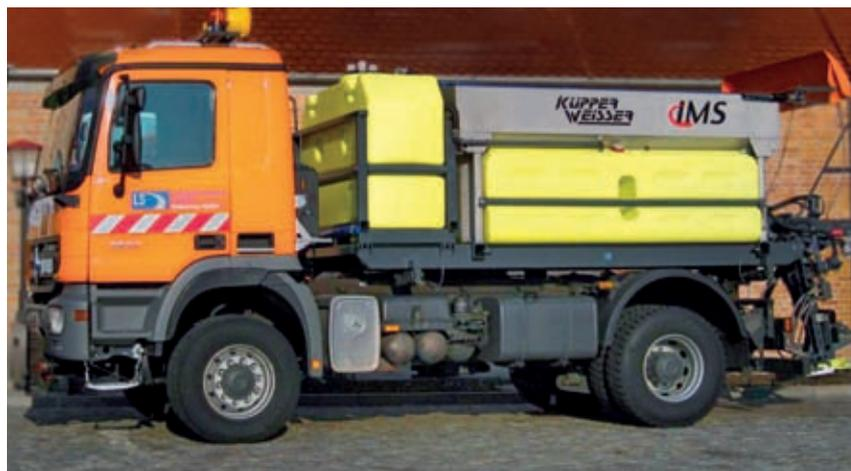
Abb. 6: Kombinations-Streugerät für FS 30 und Lösung / Combined Spreading machine for pre-wetted salt and for brine spreading
