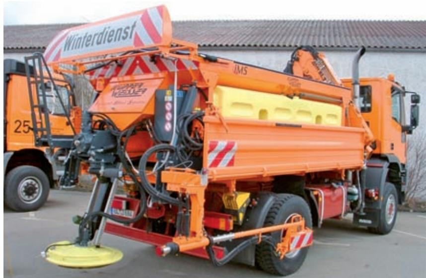
Abb. 4: Feuchtsalz-Streugerät / *Spreading machine for pre-wetted spreading*
