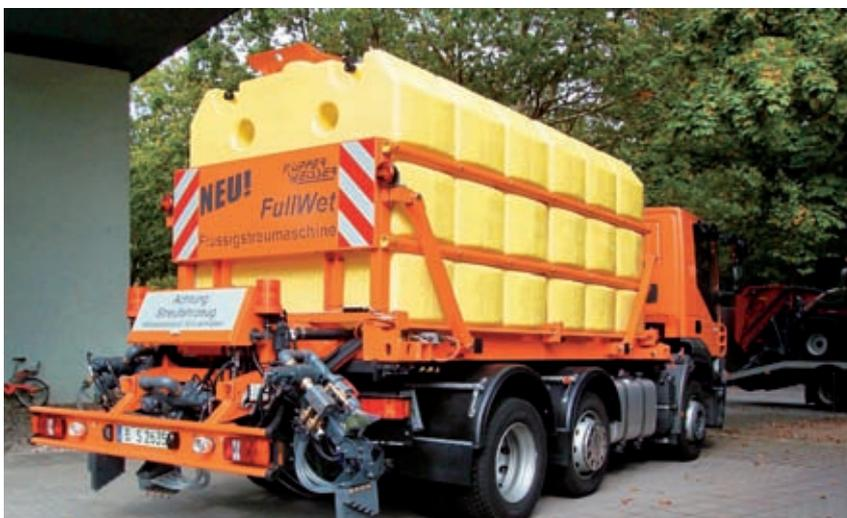
Abb. 7: Gerät für reine Lösungsausbringung / Spreading machine for pure brine spreading
