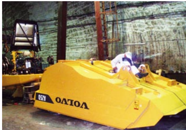
Abb. 7: Verschweißen der Muldenhälften und Montagearbeiten am Dumper A 25 D 4x4 / Welding of the body halves and assembly works of the Hauler A 25 D 4x4
