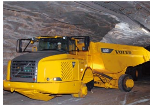
Abb. 8: Verlassen des Montageplatzes in der Hauptwerkstatt auf Stahlfelgen und Montagebereifung / Leaving of the main workshop on steel rims and assembly tyres
