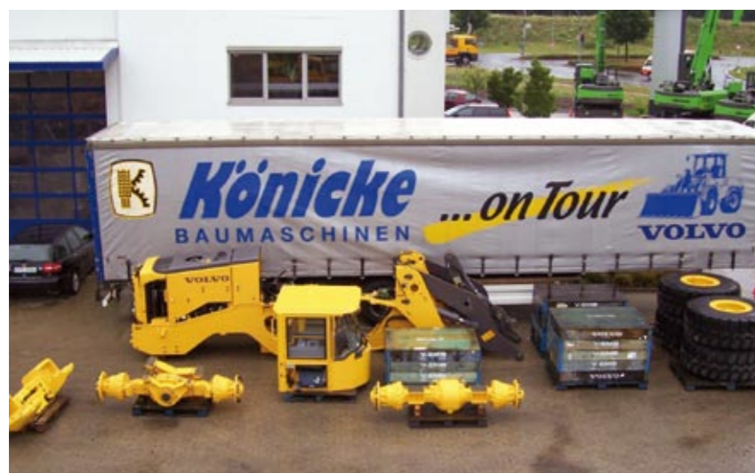
Abb. 4: Transportfertig zerlegter Radlader L110 E auf dem Hof der Volvo-Niederlassung in Garbsen / Wheel loader L110 E disassembled for transport on the property of the Volvo establishment in Garbsen
