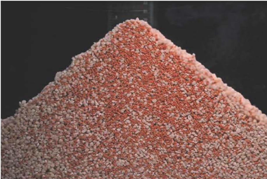
Abbildung 9: Partikelgrößenverteilung in einem aufgeschütteten Haufwerk: Der Feinanteil (hier rot dargestellt) befindet sich überwiegend im Kern des Haufwerks. Der grobe Anteil (weiß) hingegen fließt nach außen ab. Von außen ist kaum Feinanteil zu sehen
