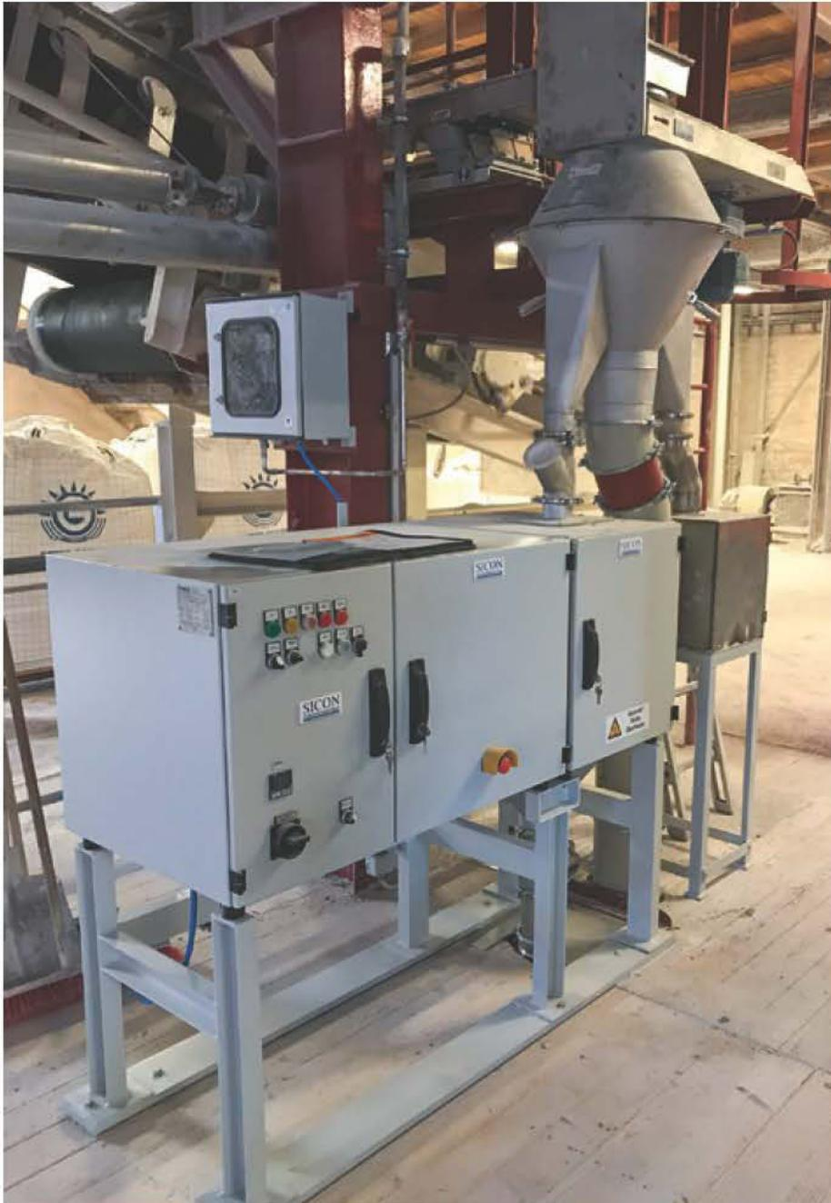
Abbildung 8: Online-Messsystem zur Bestimmung von Partikelgrößenverteilungen während eines Verladeprozesses
