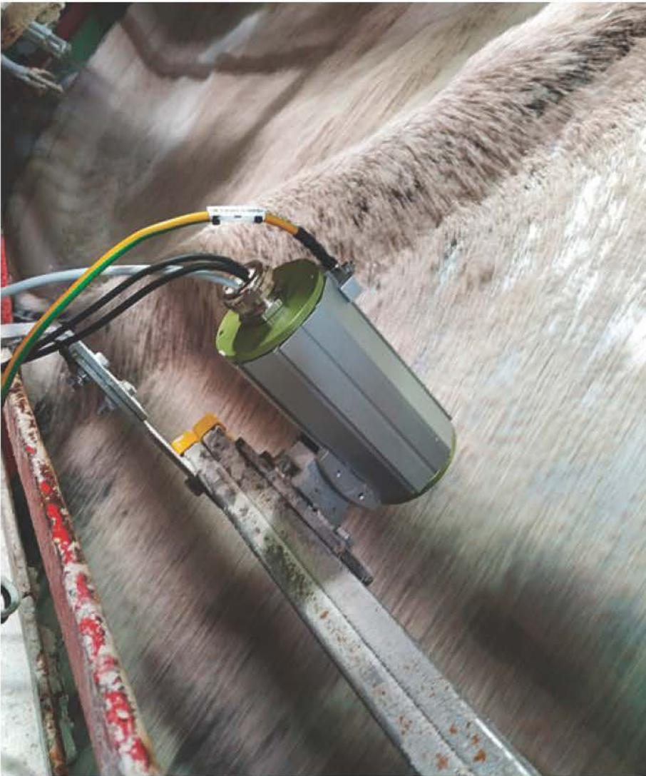
Abbildung 3: Installation von Kamera und Beleuchtung über der Abwurfschurre eines Pelletiertellers – Umsetzung im Auflichtverfahren
