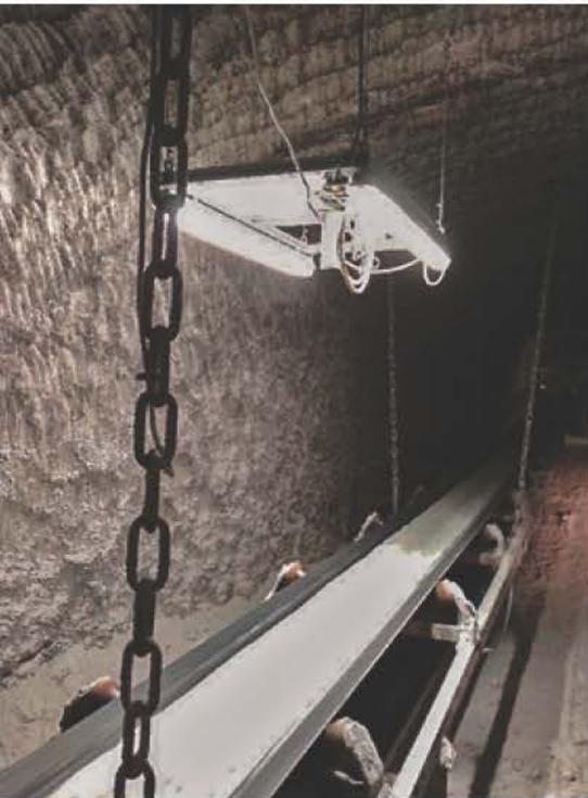
Abbildung 6: Prototyp der Dunkelbestandteilmessung, installiert über dem Rohsalzband der Steinsalzgrube
