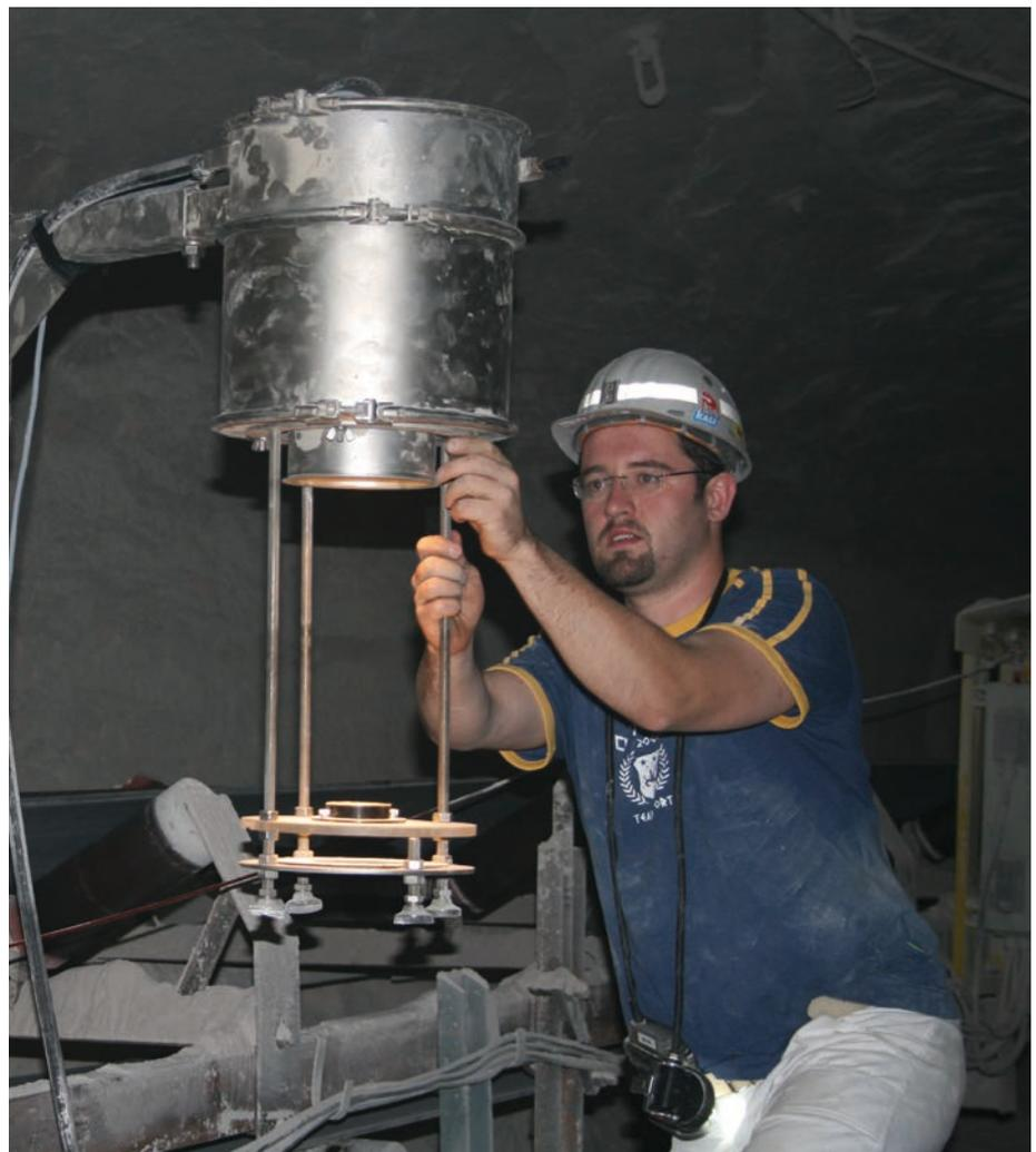
Abbildung 21: Nah-Infrarot(NIR)-Spektroskopie-Einsatz unter Tage
