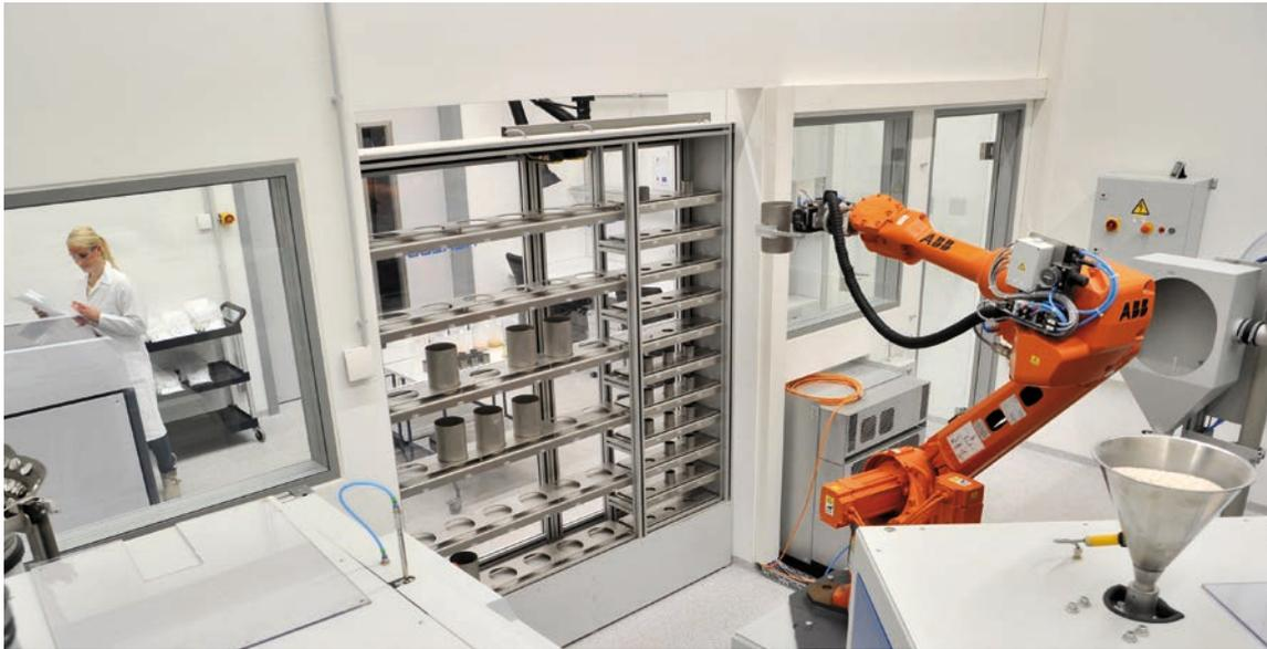
Abbildung 20: Röntgendiffraktometrie(RDA)-Robotersystem im AFZ
