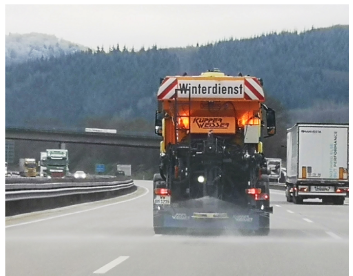
Solesprühung mit FS100-Technologie (WINDIP)
