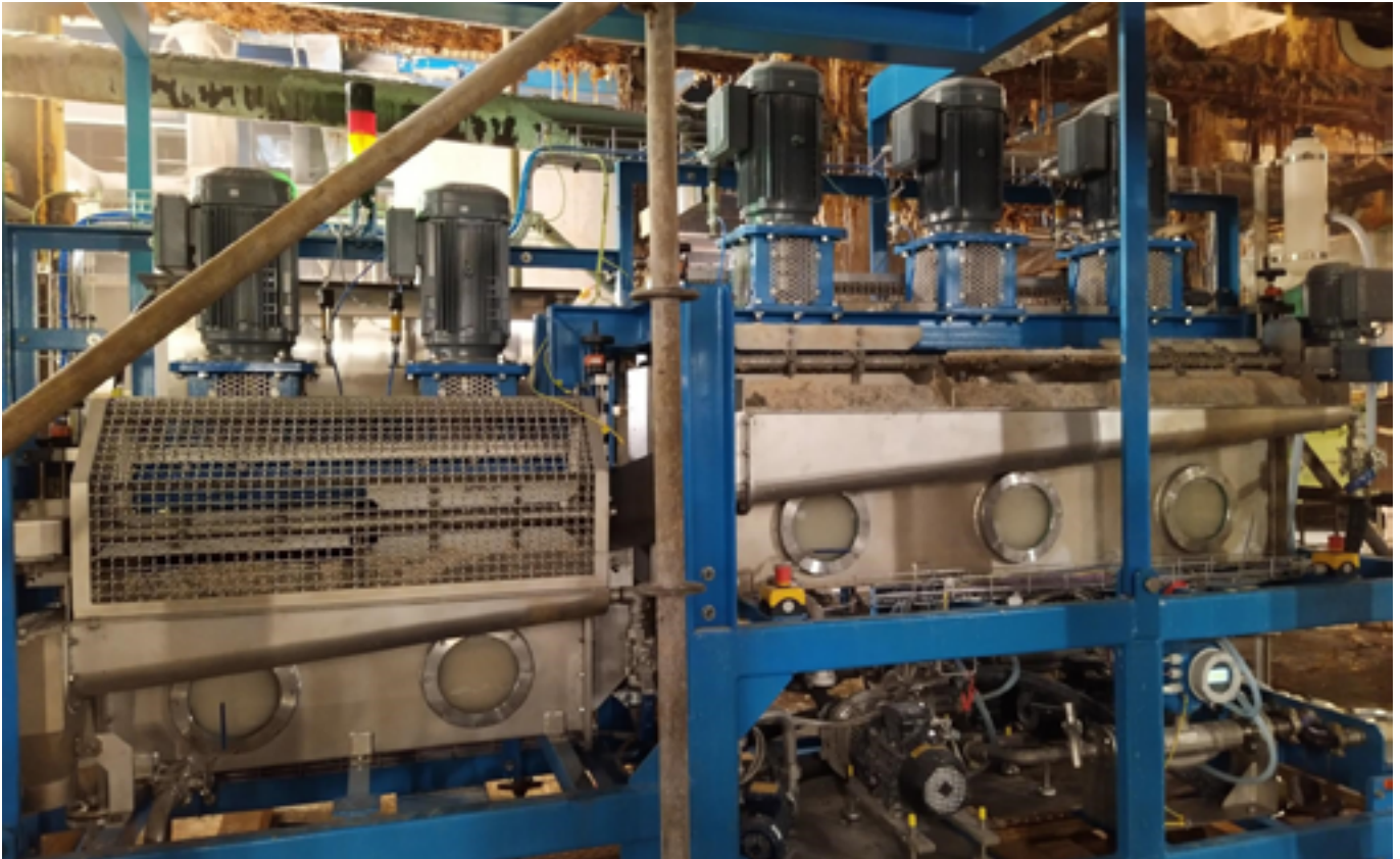
Abbildung 8: Mobile Rührwerksflotation bei einem Betriebsversuch im Werk ZI
