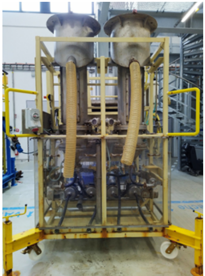
Abbildung 3: Mobile pneumatische Flotationsanlage im Technikumsmaßstab
