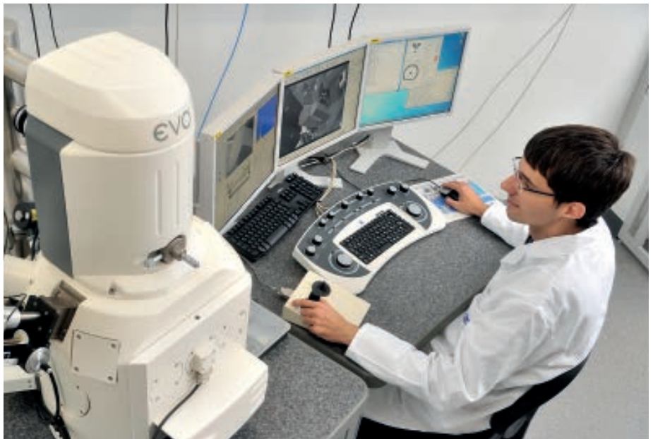
AFZ-Mitarbeiter an einem Rasterelektronenmikroskop (REM) mit Mikrosonde
