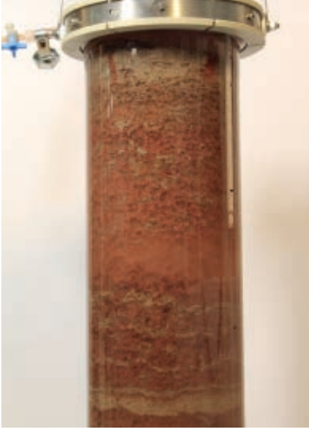
Löseversuch an einem Bohrkern vom Legacy-Standort
