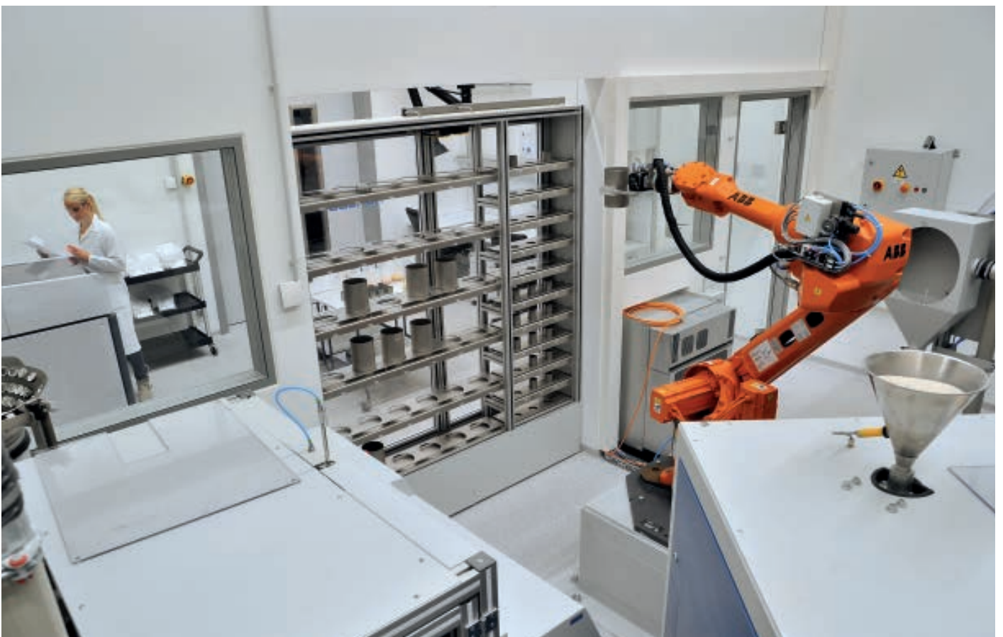
Vollautomatisiertes Robotersystem zur Mineralphasenanalytik
