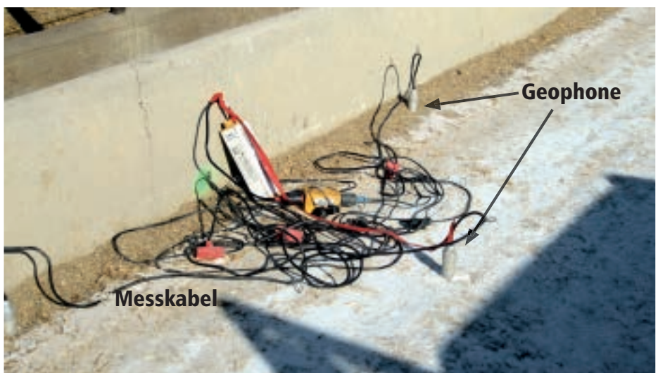
Abb. 12: Messpunkt mit Empfängern (Geophone) und Messkabeln für die Aufzeichnung der seismischen Signale
