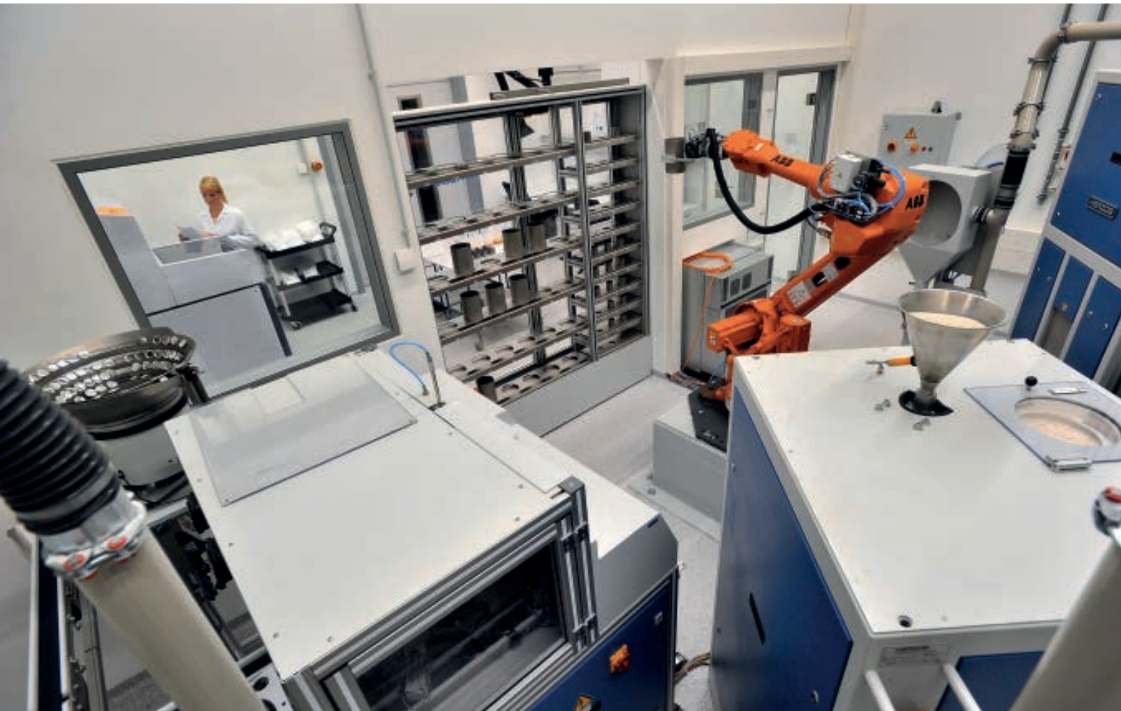
Abb.11: Messaufbau mit Roboter, Grob- und Feinmühle, Dosierstation und Backloadingpresse, K+S
