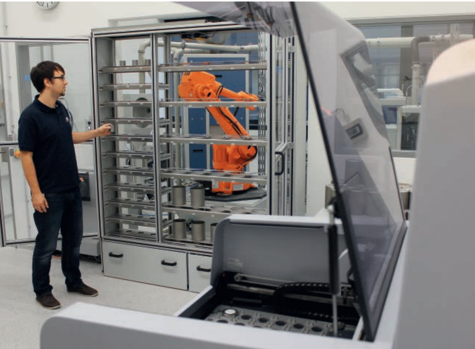
Abb.12: Messaufbau mit zentralem Regalmagazin und Prozessdiffraktometer
