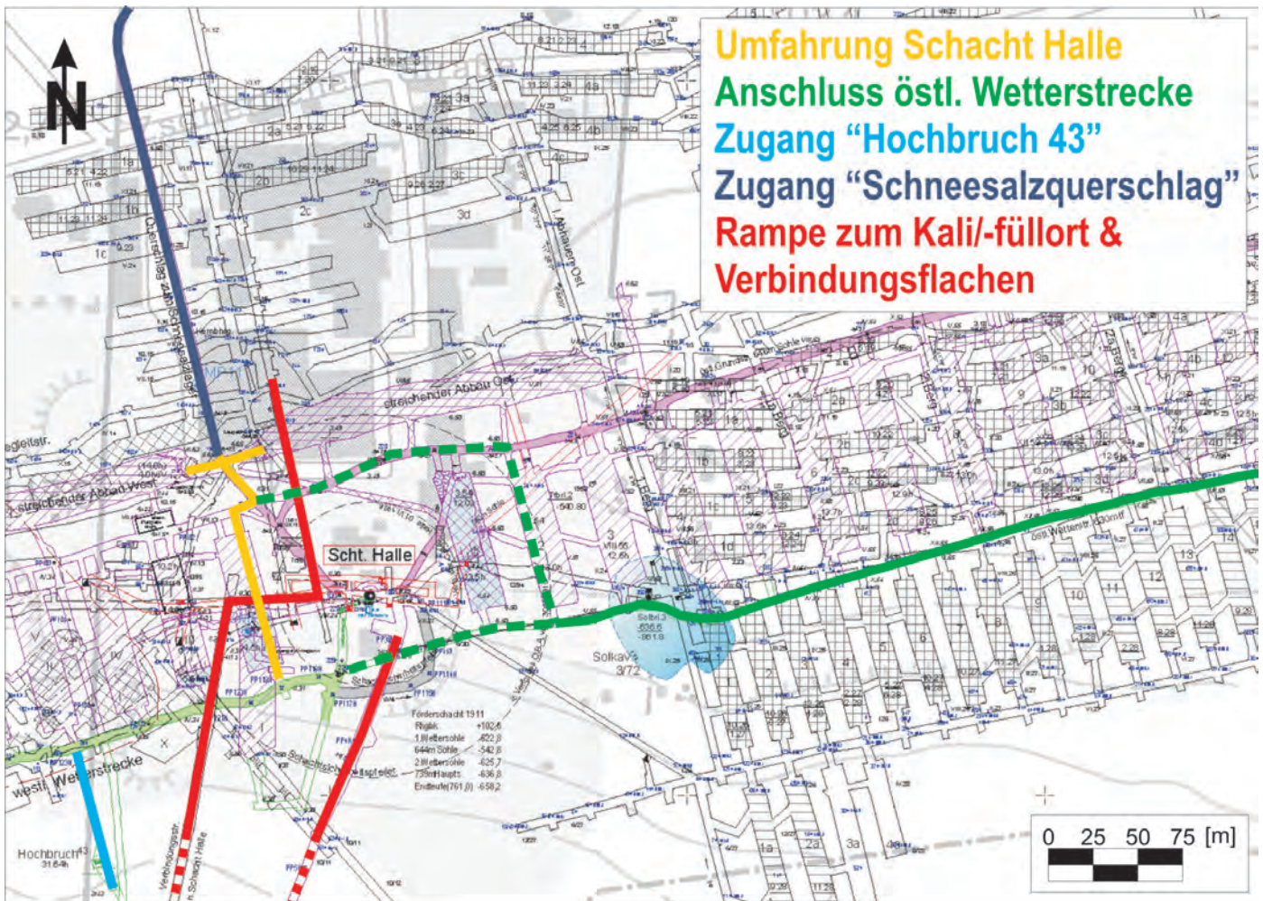
Abb. 3: Grubenrissausschnitt des Grubenfeldes Angersdorf mit den 5 geplanten Teilmaßnahmen. (Quelle GTS)
