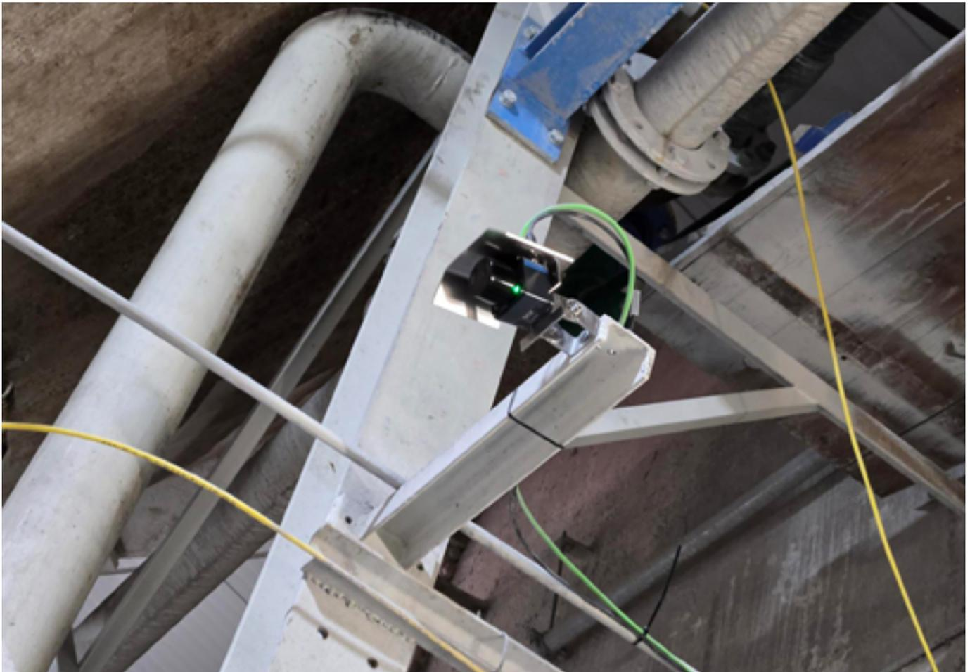
Abbildung 2: Owl Eye® LiDAR Sensor über einem Förderband
