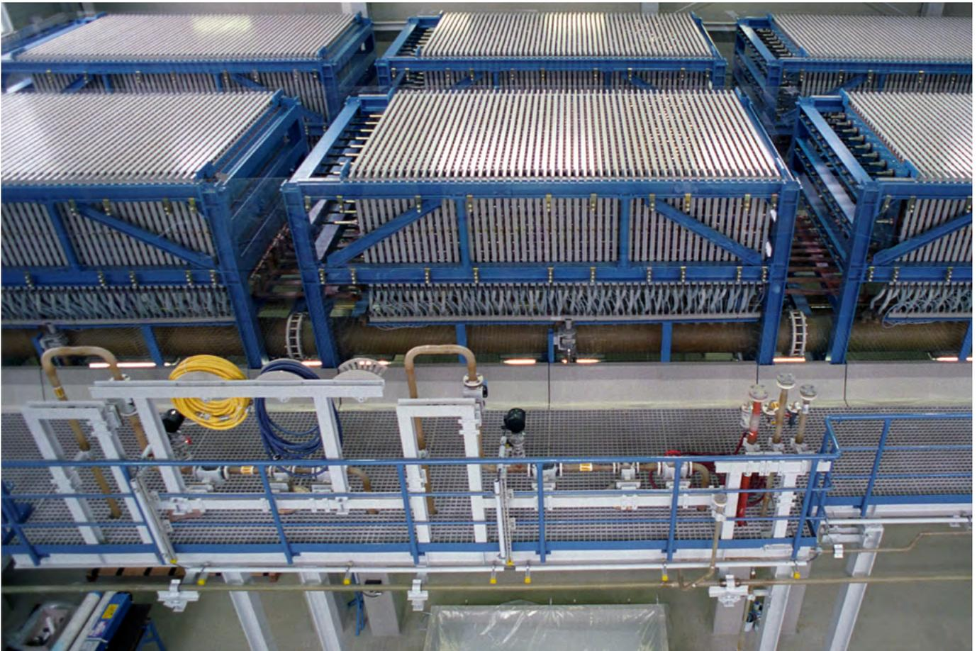
Abbildung 4: Der Zellaal von oben mit den beiden Elektrolyseuren im größten WACKER-Werk im bayerischen Burghausen.
