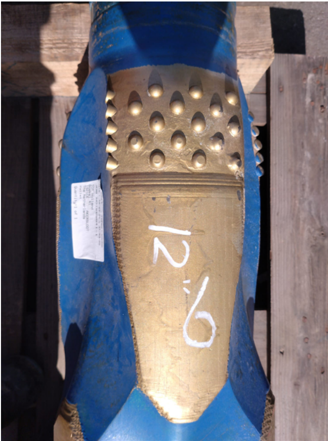
Abbildung 9: 12" Hybrid-Dome Reamer; dieser fungierte als oberster Stabilisator in der BHA, welcher zugleich nachkriechendes Salz weg-schneiden konnte.
