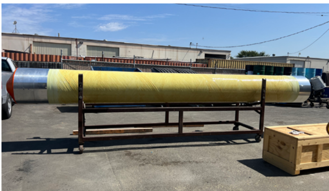
Abbildung 3: Spezialanfertigung des 26" Rohrschuhs; hier nach Fertigstellung in Texas.
