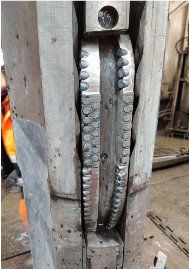
Abbildung 4: Eingesetzte Unterschneider (Underreamer): Links zu sehen ein Block des 16" Underreamer nach Unterschneiden der langen Tangentensektion und rechts ein Block des 17 1/2" „Rhino“ Underreamer, welcher im Salz zum Einsatz kam.
