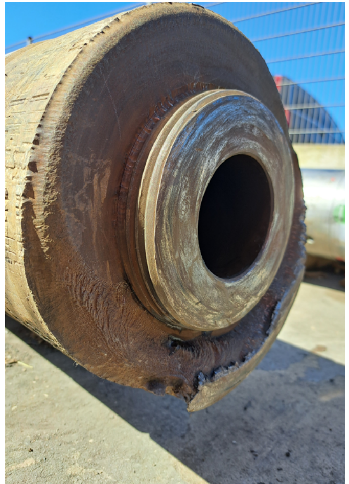
Abbildung 7: Blick auf die abgerissene Muffe der Schwerstange. Der Zapfen des oberen Rohres ragt noch etwa hervor.
