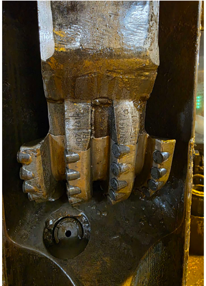
Abbildung 4: Eingesetzte Unterschneider (Underreamer): Links zu sehen ein Block des 16" Underreamer nach Unterschneiden der langen Tangentensektion und rechts ein Block des 17 1/2" „Rhino“ Underreamer, welcher im Salz zum Einsatz kam.
