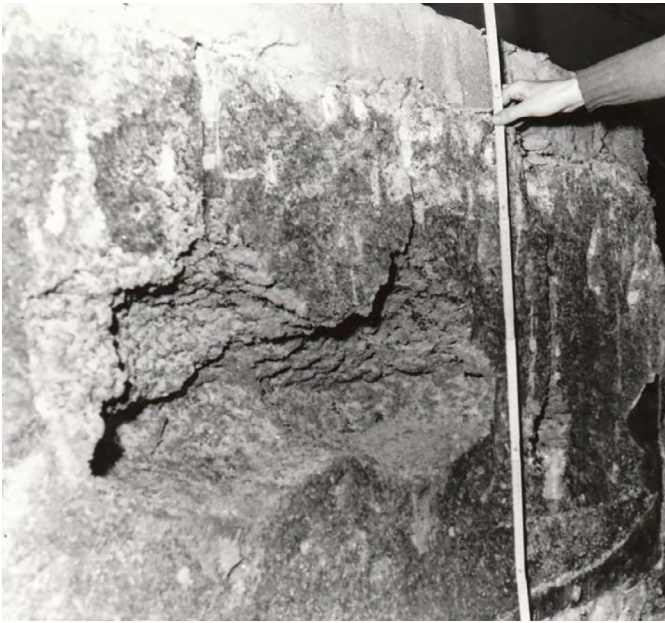
Abbildung 4: Carnallitblock mit Kaverne
