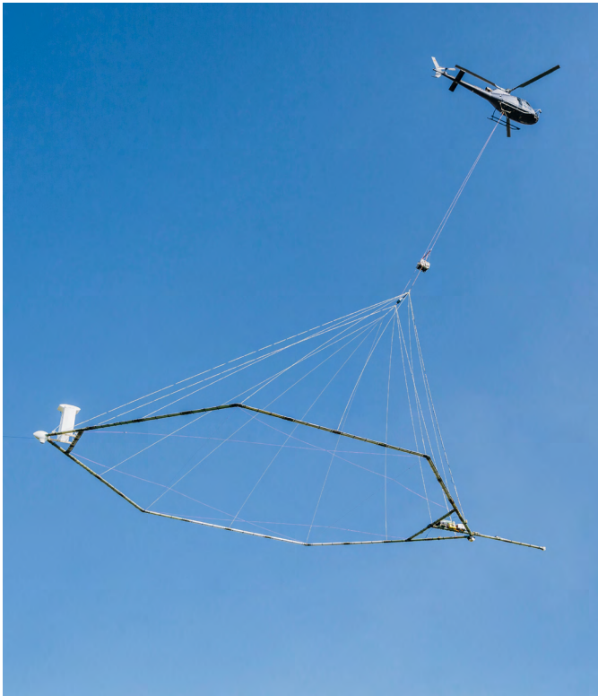
Abbildung:2: Hubschrauber mit hängendem TEM-Messgerät im Einsatz zur geophysikalischen Erkundung des Untergrunds (Quelle: K+S AG)
