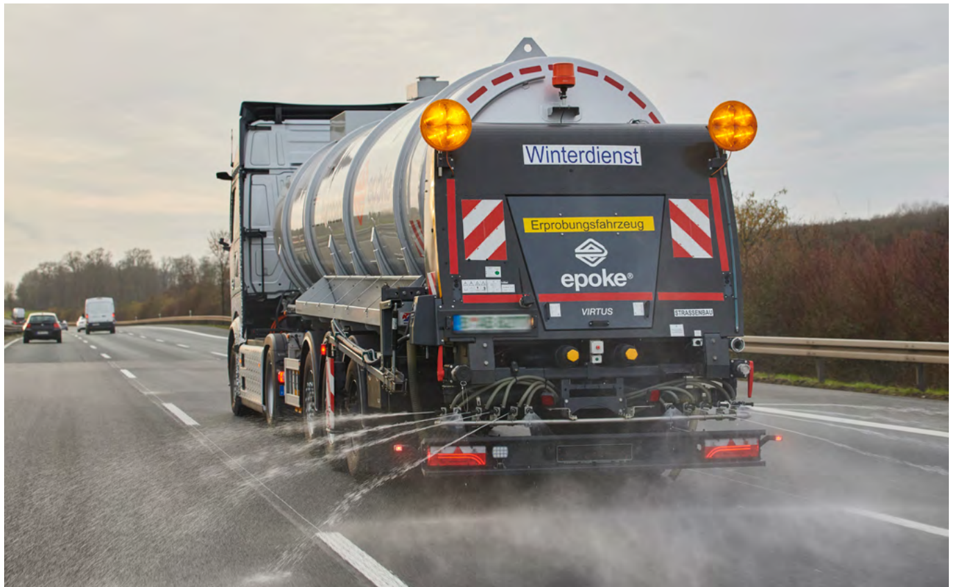
Abbildung 5: Batterieelektrischer Lkw mit Solesprüher-Auflieger im Einsatz (Quelle: Daimler Truck)
