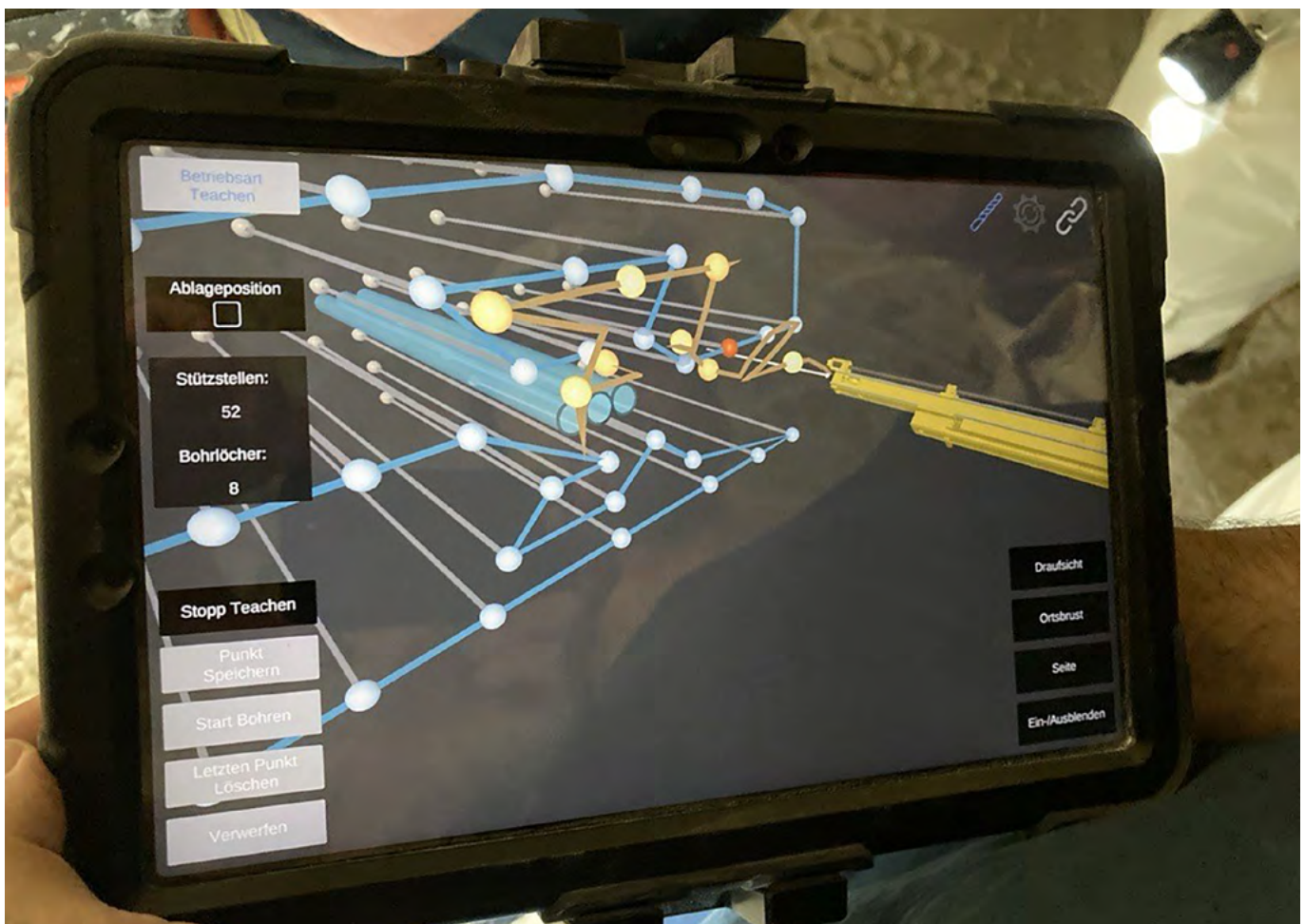
Abbildung 3: Tablet zur Bedienung und visuellen Darstellung der Sprengbohrlöcher
