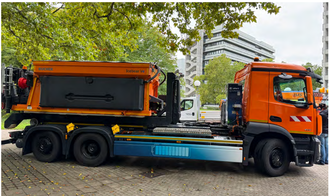
Abbildung 6: Batterieelektrischer 3-Achser-Lkw mit Elektrostreuer für FS30 und FS100
