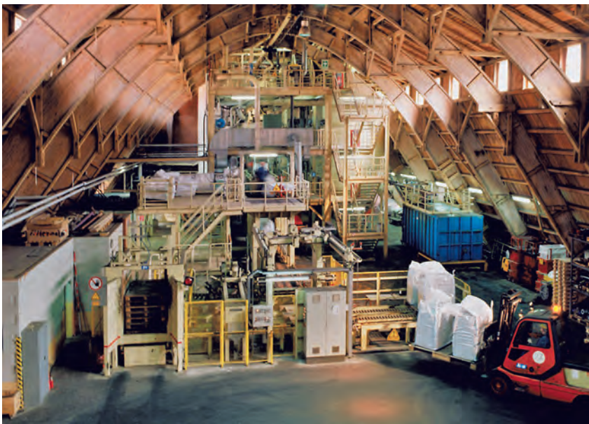
Abb. 5: Übertägige chemisch-physikalische Behandlung der Abfälle in der Untertageverwertungsanlage Hattorf-Wintershall, Standort Hattorf – Quelle: K+S
