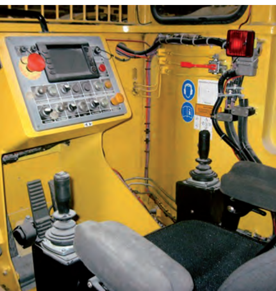
Abb. 5: Fahrerstand mit schwenkbarer Fahrersitzkonsole
