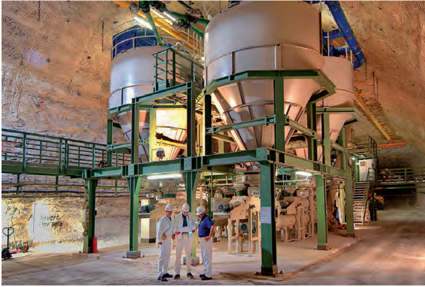
Abb. 4: Untertägige chemisch-physikalische Behandlung der Abfälle in der Untertageverwertungsanlage Unterbreizbach – Quelle: K+S
