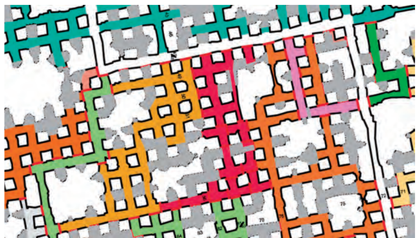
Abb. 2: Ausschnitt aus dem Grundriss einer Untertagedeponie; die Stoffgruppen sind durch verschiedene Farben gekennzeichnet. Quelle: K+S
