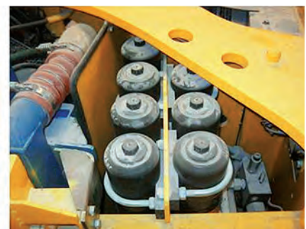
Abb. 3: Hydraulischer Bremsybrid HBH im SLP12/14H
