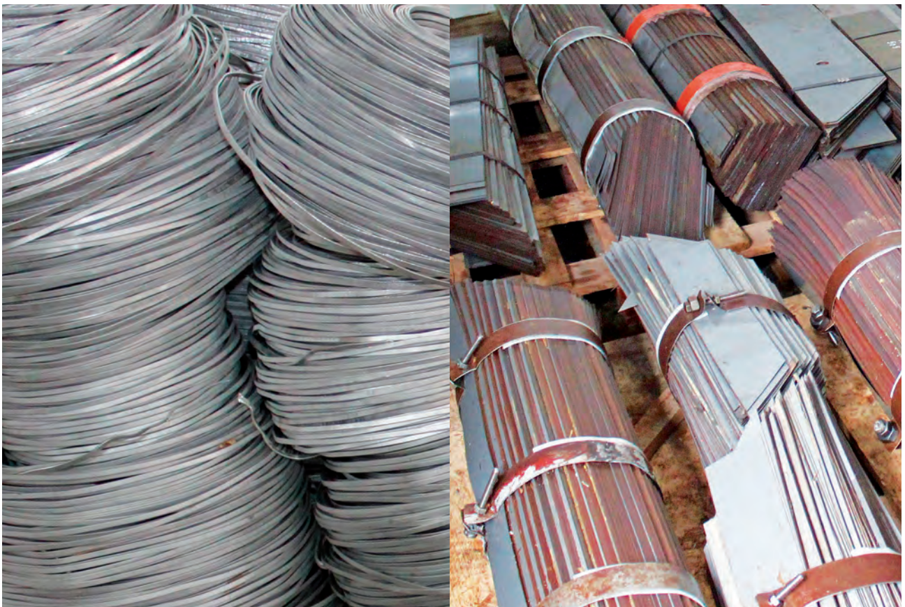
Abb. 8: Die nach der Reinigung und Zerlegung von Transformatoren erhaltenen Wertstoffe Kupfer, Aluminium und Weicheisen, Fotos: K+S
