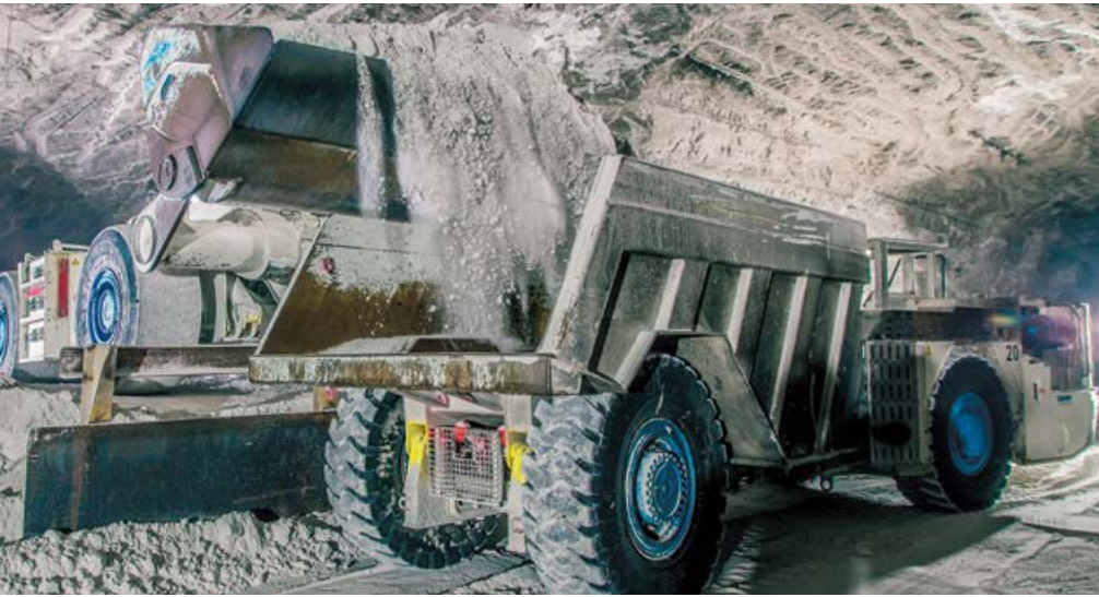
Kombination aus Fahrlader und Truck zur Förderung bei Entfernungen über 300 m, Quelle: GHH Fahrzeuge
