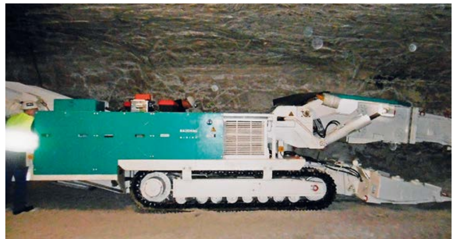
Teilschnittmaschine Hazemag NTM-C100, Quelle: Hazemag & EPR GmbH
