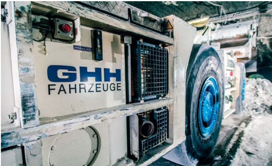
Fahrlader mit SCR-Modul und Dieselpartikelfilter, Quelle: GHH Fahrzeuge
