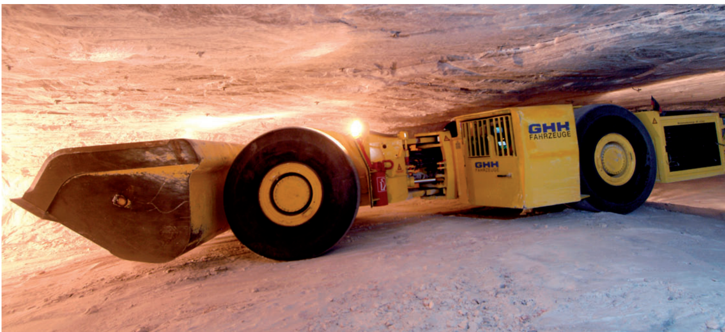
Abb. 20: Speziell konstruierter, flacher Lader für niedrige Abbaubereiche im Grubenbetrieb Hattorf/Wintershall des Werkes Werra 18
