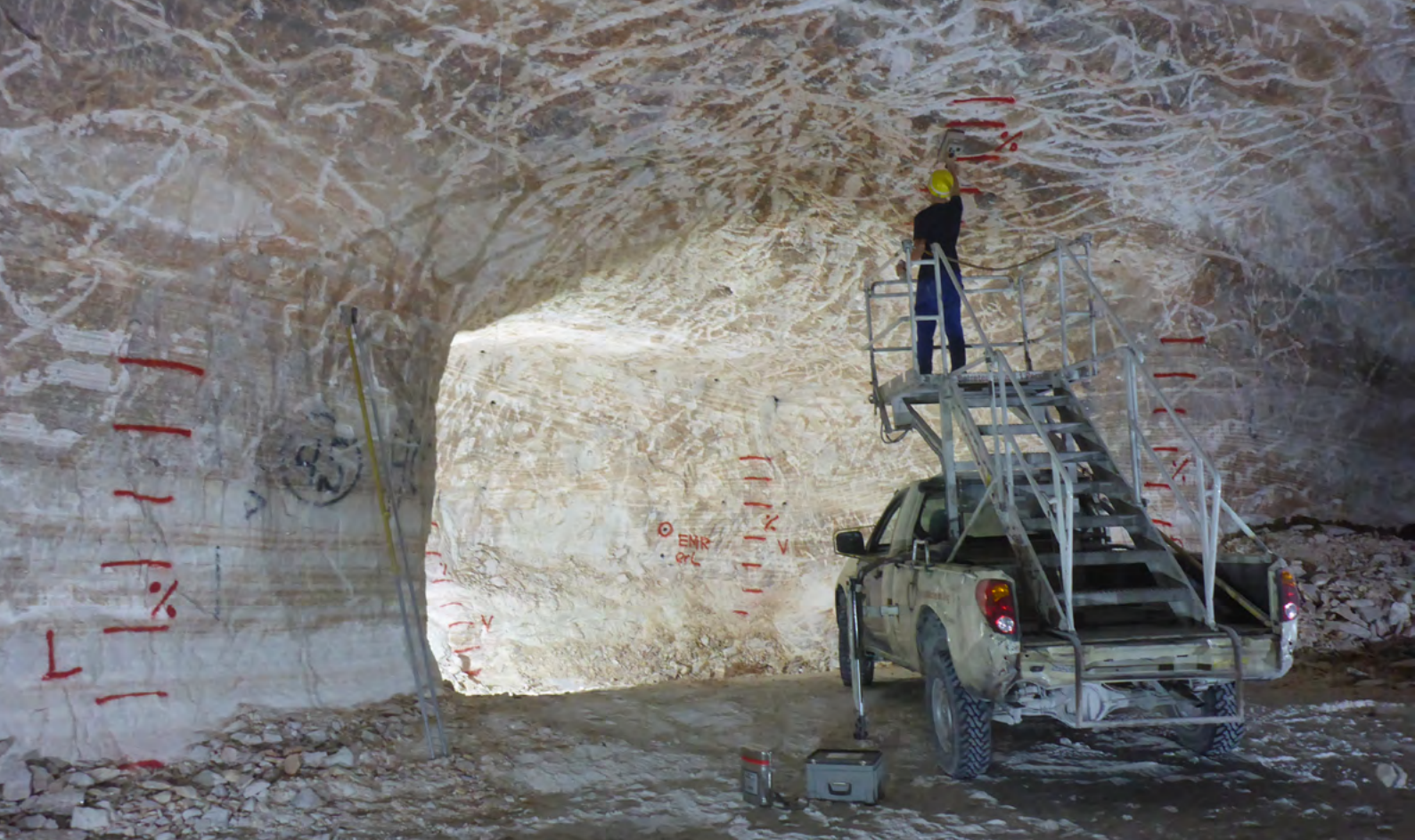
Abbildung 2: Praktische Messungen mit dem Handkalimeter an der Firste der Grube Zielitz.
