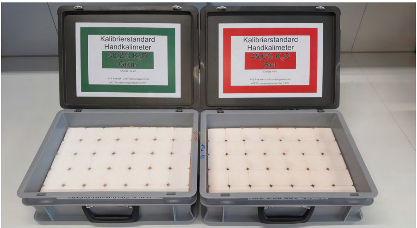
Abbildung 4: Beispiele für Standards für die Kalibration der Handkalimeter. Salzlecksteine mit unterschiedlichen \text{K}_2\text{O} -Gehalten die mithilfe eines Sorelzementes in Koffern fixiert wurden.
