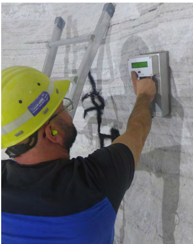
Abbildung 1: Praktische Durchführung der Handkalimetermessung unter Tage an einem Stoß. Der K_2O -Gehalt der obersten Schicht an der Messfläche wird zerstörungsfrei bestimmt.
