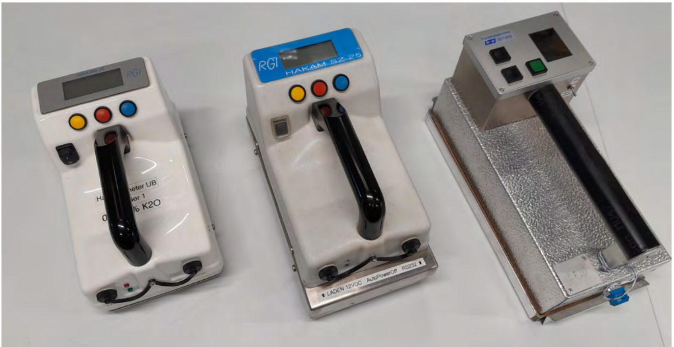
Abbildung 5: Fotografie der betrachteten Handkalimeter, von links nach rechts: HAKAM 31, HAKAM SZ 25, ELMIG.
