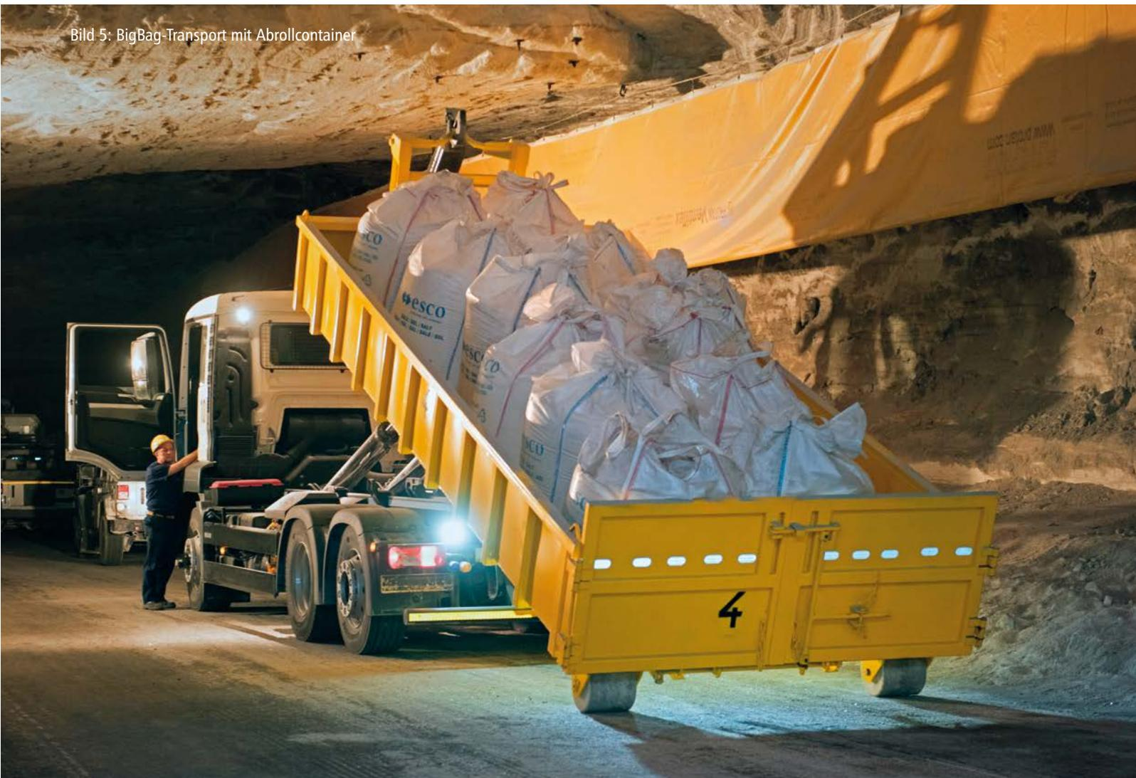
Bild 5: BigBag-Transport mit Abrollcontainer
