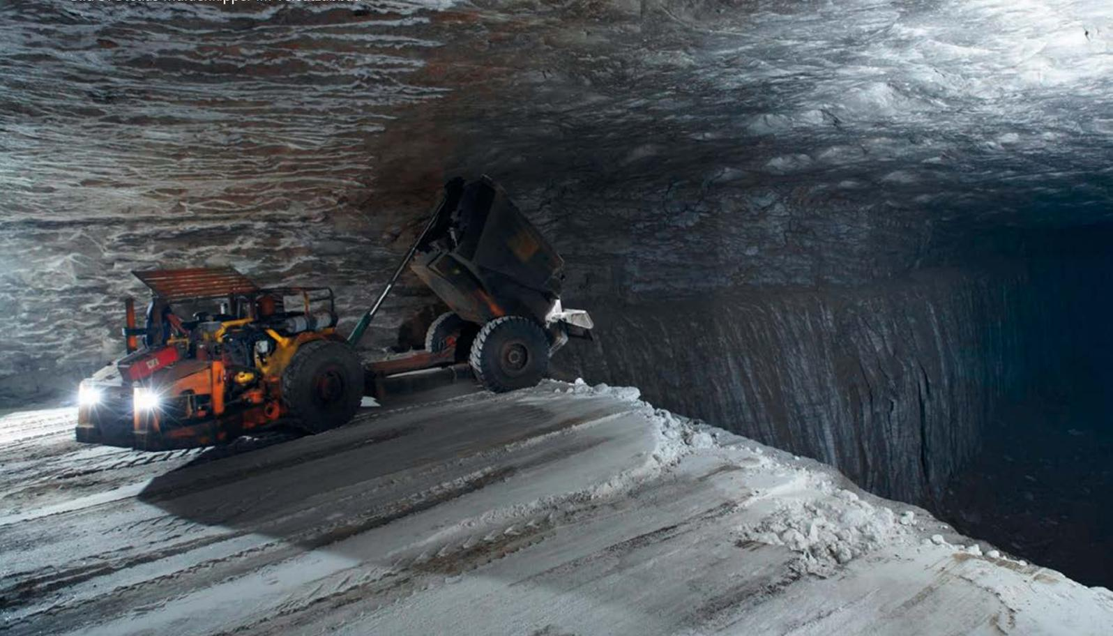
Versatzkammern gefahren und an der Böschung abgekippt (Bild 2).
