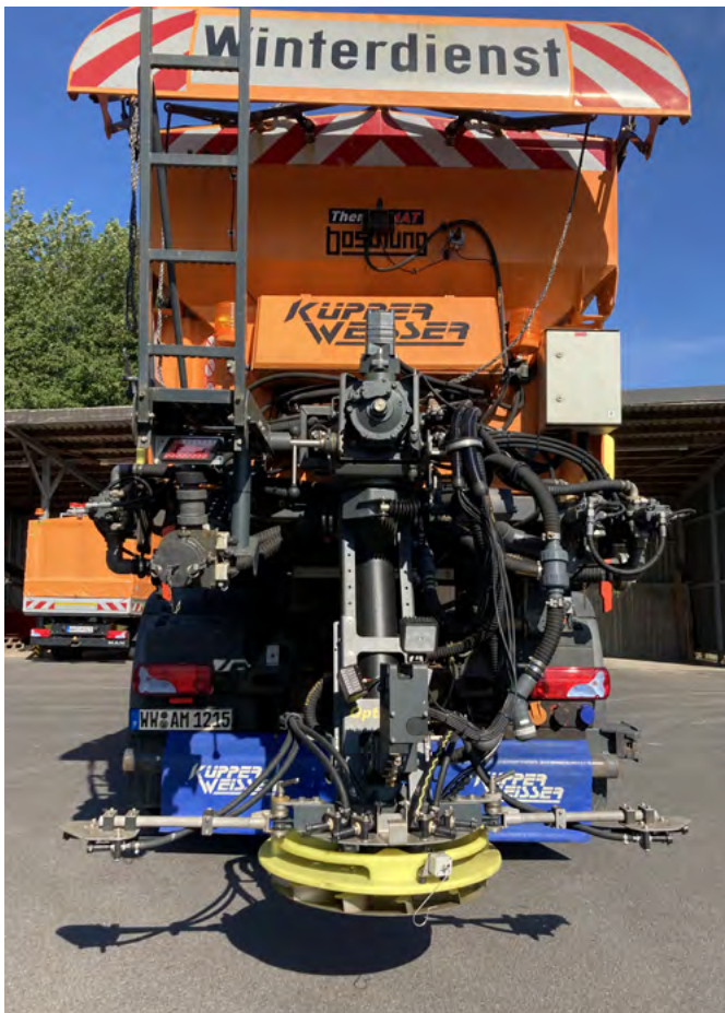
Abbildung 7: Hybrid-Streumaschine für FS30 und FS100 (Quelle: Autobahnmeisterei Mendig)
