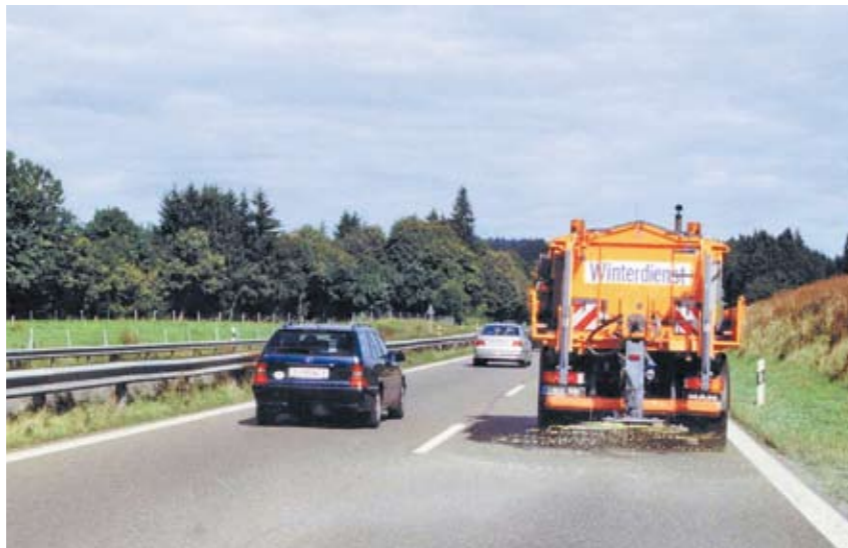
Abb. 2: Streubild Feuchtsalzausbringung / spreading pre-wetted salt
