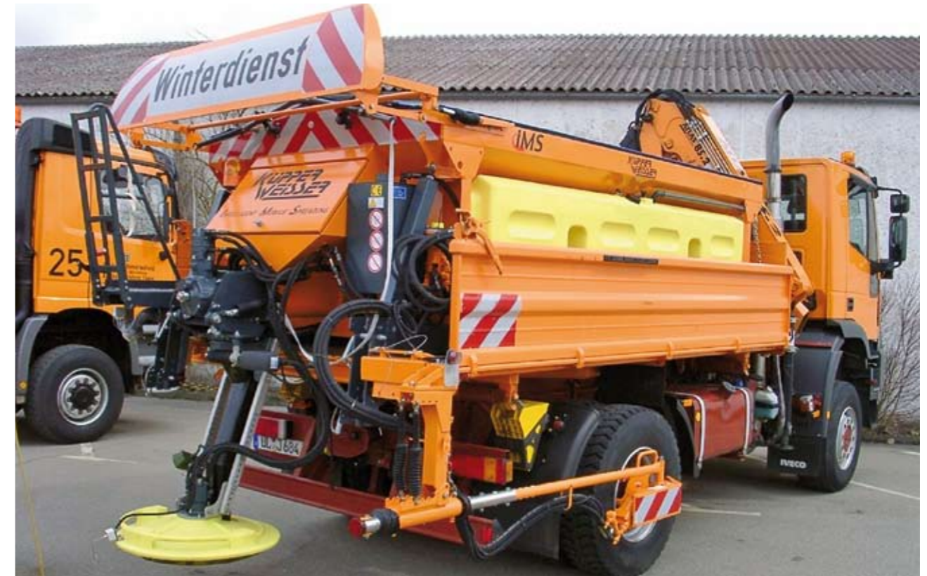
Abb. 1: Feuchtsalz-Streufahrzeug / typical spreader for pre-wetted salt
