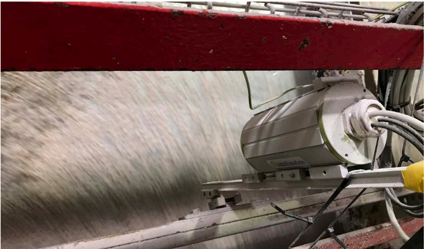
Abbildung 3: Kamerasystem im Aufsichtverfahren direkt am Tellerabwurf.
