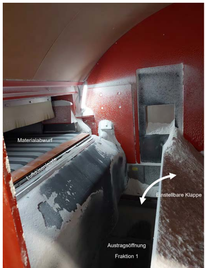
Abbildung 1: Innenraumaufnahme eines sensorgestützten Sortierers der Firma TOMRA Sorting GmbH.
