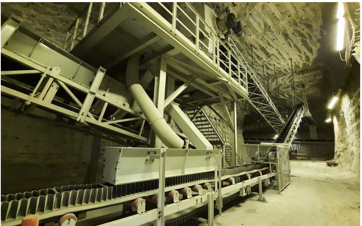
Abbildung 5: Rückführung von Über- und Unterkorn zur Schachtförderung. [Foto: F. Schumann, Fa. K+S]
