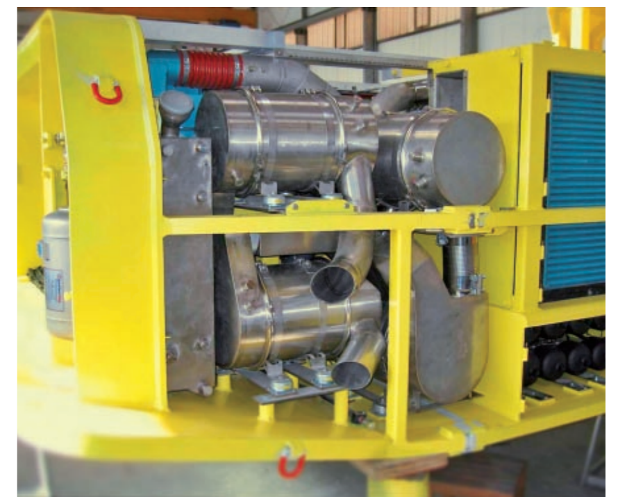
Abb 3: Zweistufiges Abgasnachbehandlungssystem SCRT von Johnson Matthey am Fahrlader LF 20 (GHH Fahrzeuge) | Two stage exhaust after treatment system SCRT from Johnson Matthey on loader LF 20 (GHH Fahrzeuge)
