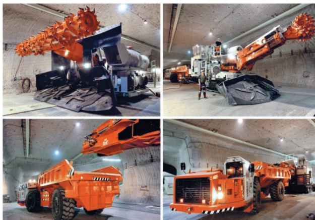
Abb. 8: Continuous Miner, Teilschnittmaschine und Schiebekastenfahrzeug nach Montage (Fotos: Straub)
