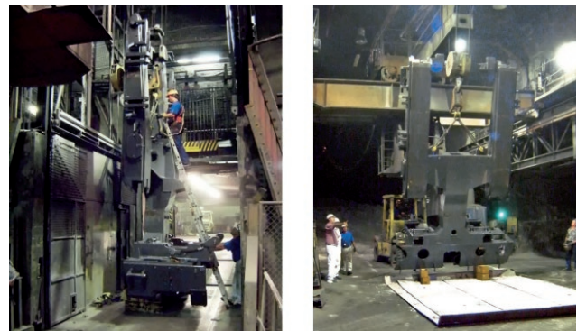
Abb. 6: Aushängen unter Tage und Transport der Großkomponenten
