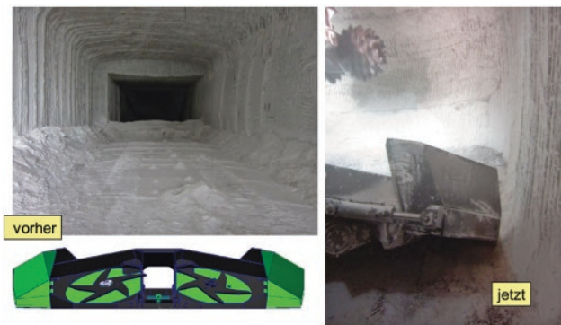
Abb. 10: Situation vor und nach der Ladetischverbreiterung
