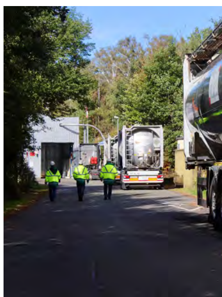
ADR-Silotanks vor der Verladehalle für ANEX LD [5]
