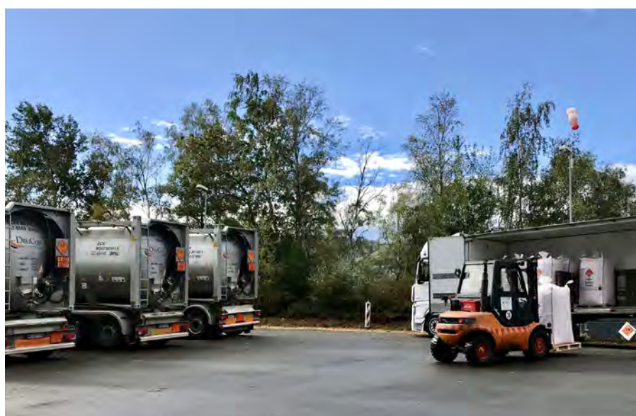
Moderne Sprengstofflogistik mit ANEX LD in ADR-Silotanks und in Big Bags [5]
