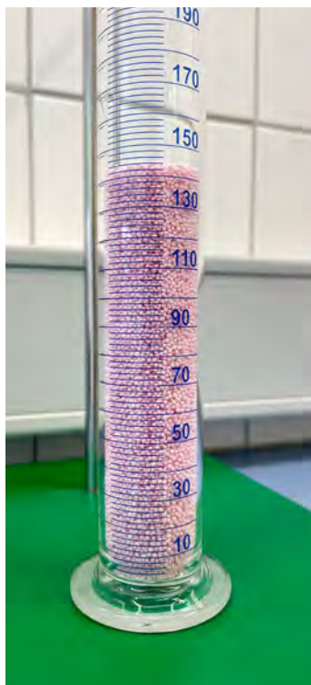
Qualitätssicherung für den ANC-Sprengstoff ANEX LD, hier Bestimmung der Schüttdichte [5]
