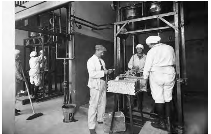
Patronieren der Mischung von Kaliumchlorat und Holzmehl im Patronierhaus [5]
