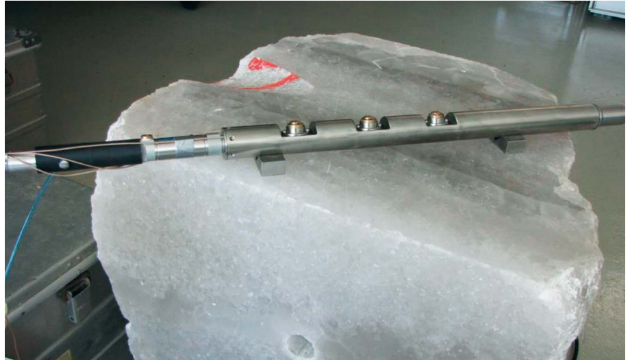
Abb. 3: Bohrlochsonde zur Bestimmung von Auflockerungszonen mittels Ultraschallmessungen
