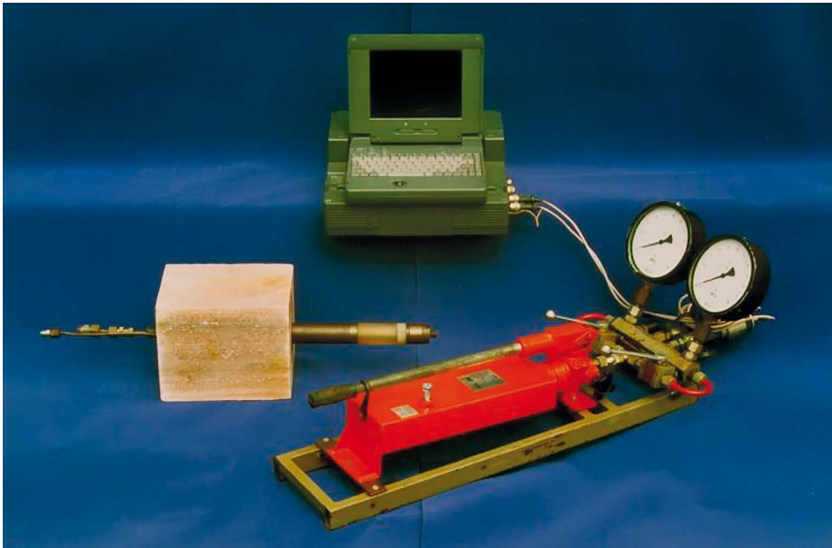
Abb. 1: Frac-Equipment für Bohrl Lochdurchmesser von 42 mm des IfG Leipzig
