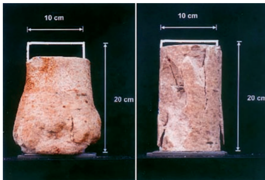
Bild 3: Probekörper nach Triaxialversuchen mit unterkritischer (links) und ueberkritischer (rechts) Verformungsrate / Specimen of triaxial tests with various creep rates
