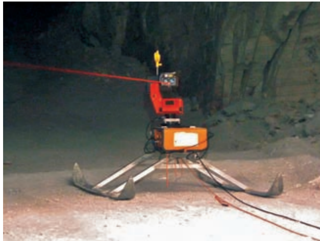
Amberg-Profiler bei der Messung / Amberg-Profiler at work
