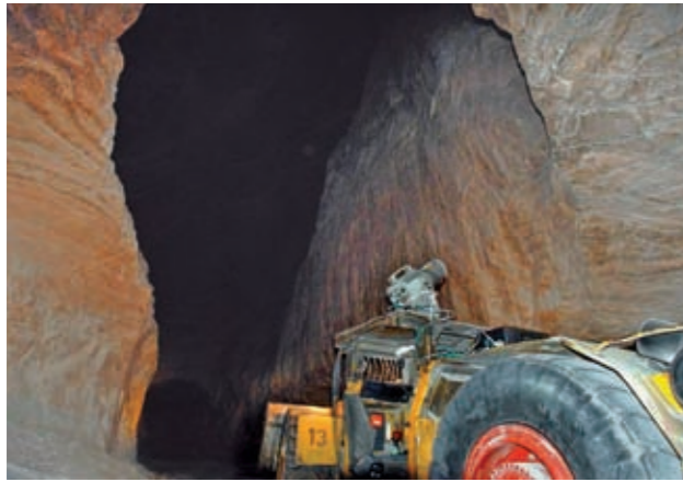
Lader mit Scanner vor einer Kuppe / LHD with scanner in front of a dome
