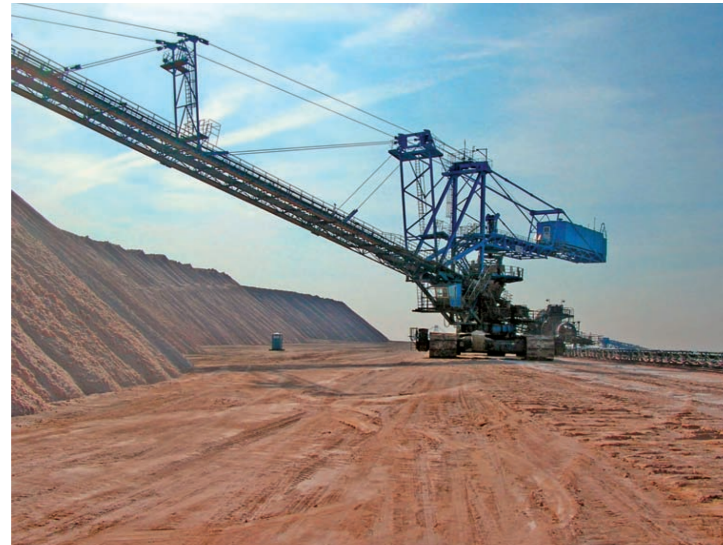
Bild 7: Absetzer auf einer Salzhalde / Spreader on a heap
