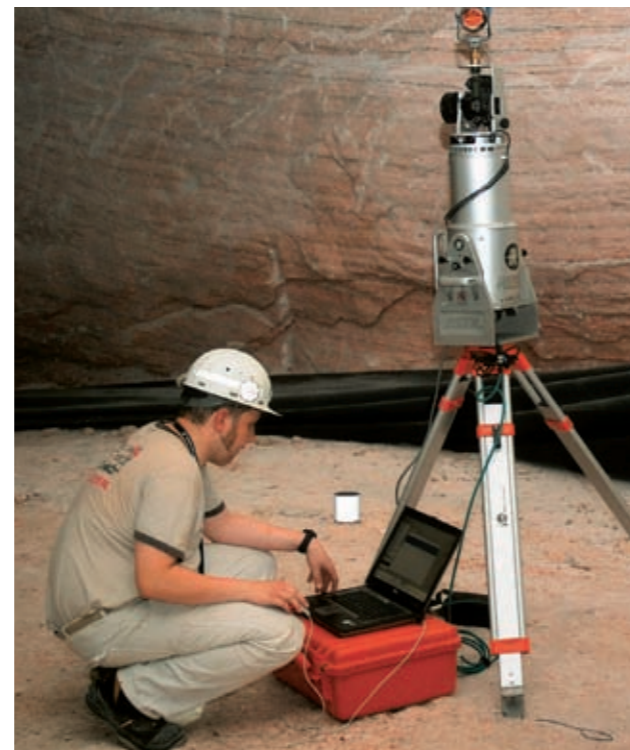
Vermessungsingenieur im Einsatz mit dem Riegls-Scanner / Mine Surveyor at work with Riegls-scanner
