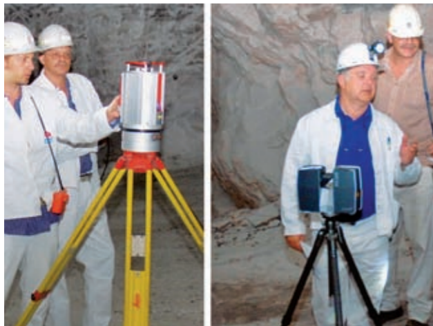
Testmessungen, links RIEGL, rechts FARO / Test scanning, left RIEGL, right FARO
