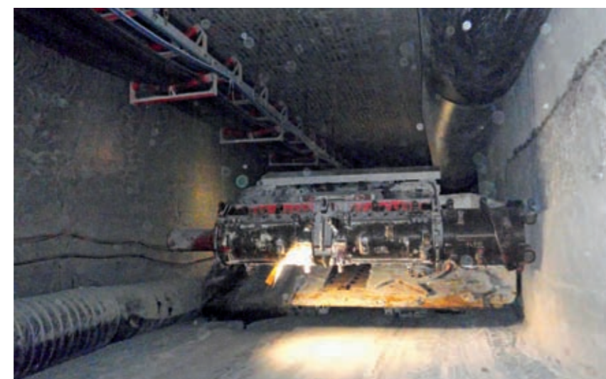
Abb. 7 b: Umsetzen des Continuous Miners durch die Einzelstrecke / Implementation of Continuous Miner through the drift
