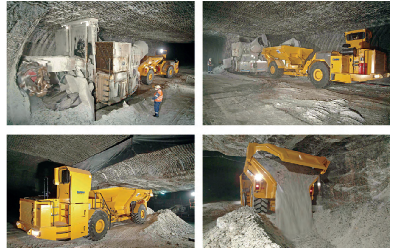
Abb. 9: Verwendung von Schiebekastenfahrzeugen zur Abförderung / Use of teledump trucks for the haulage
