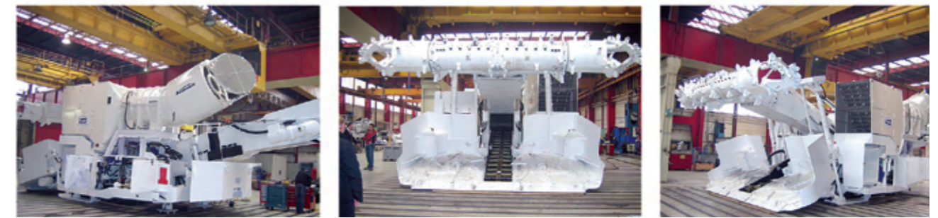
Abb. 6: Endmontage der Maschine im Herstellerwerk / Installation of the miner in the workshop of Voest-Alpine /Zeltweg
