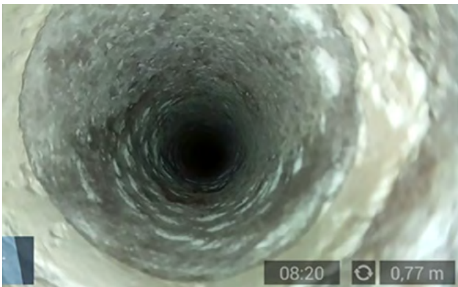
Abbildung 5: Verfüllte Klüfte in einer nachträglich erstellten Bohrung
