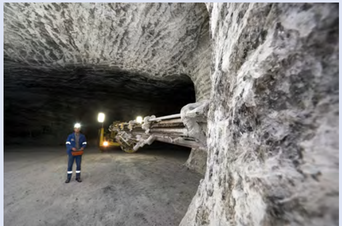
Mitarbeiter im Salzbergwerk Stetten. Er steuert einen Streckenbohrwagen, mit dem Löcher zum Herausprengen des Steinsalzes gebohrt werden.
