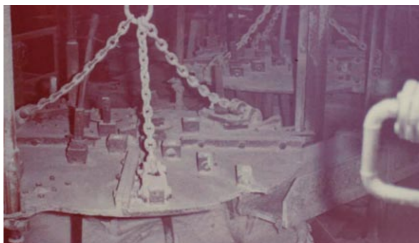
Abb. 5: Herstellung von „Rührsalz“ in Rührpfannen / Production of "scrambled salt" in stirring-pans
