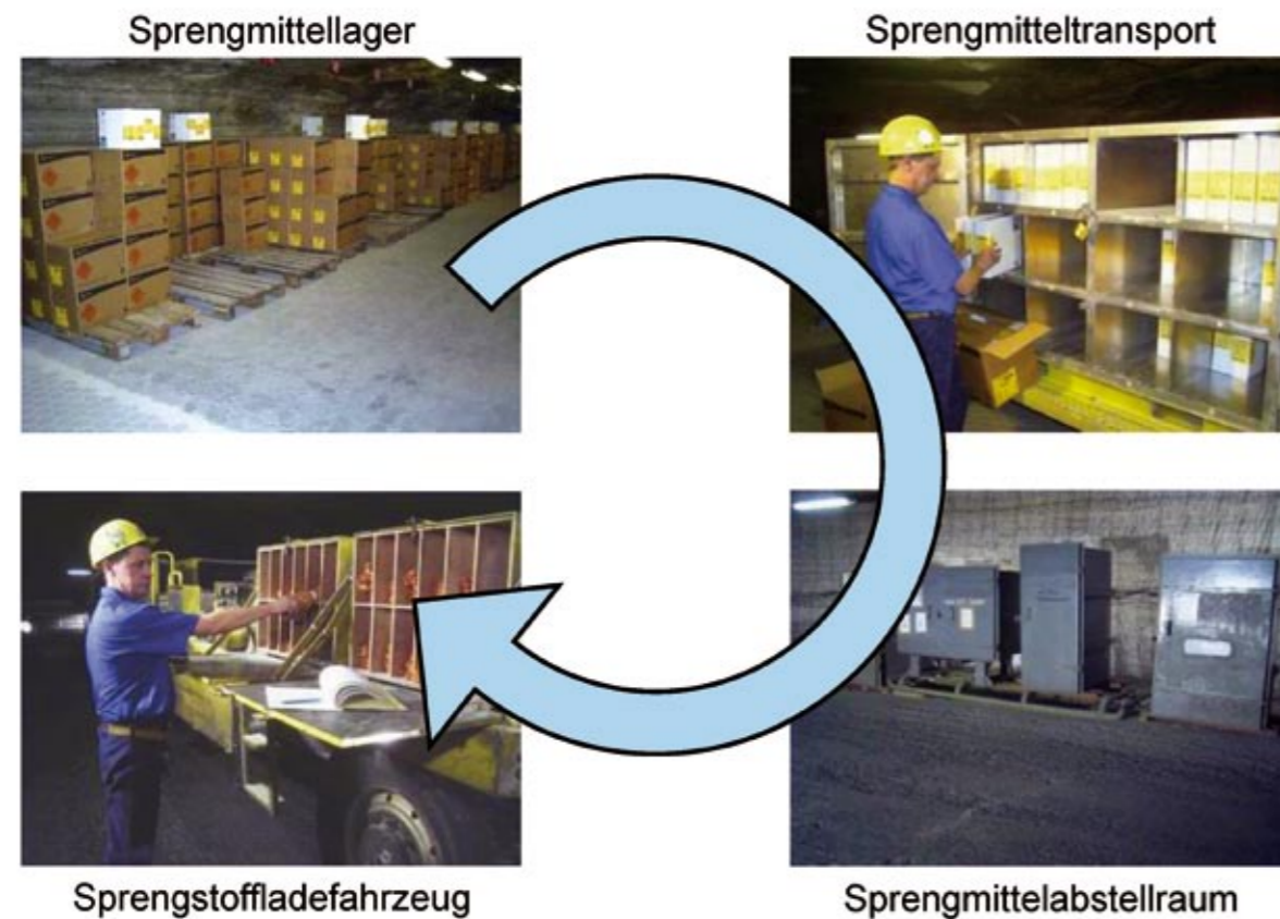
Abb. 5: Sprengmittellogistik unter Tage – Sprengzünder Variante 1/Underground Explosives Logistics – Detonators Variant 1
