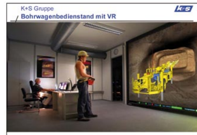
Abb. 13: Bohrwagenbedienstand mit virtueller Realität / Drill jumbo control panel with virtual reality
