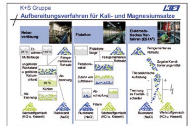
Abb. 11: Aufbereitungsverfahren für Kali- und Magnesiumsalze / Processing methods for potash and magnesium salts
