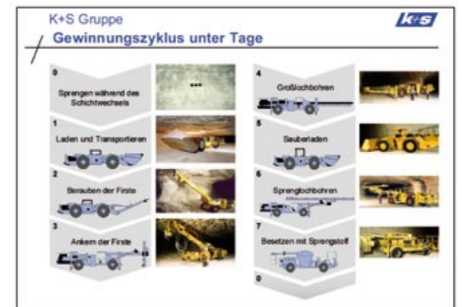
Abb. 10: Gewinnungszyklus unter Tage / Underground extraction cycle
