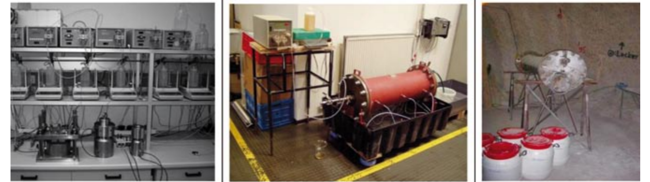
Abb. 4: Labor- und Technikumsversuche mit SVV; links in Druckzellen unterschiedlicher Form und Größe, Mitte und links Druckrohre mit unterschiedlichen Längen und Durchmessern im Technikum und im Salzbergwerk Asse / Experiments with SVV in the laboratory and the technical center: (left) in pressure cells of different sizes and geometries, (center and right) in pressure tubes of different length and diameters in the technical center and in the Asse salt mine
