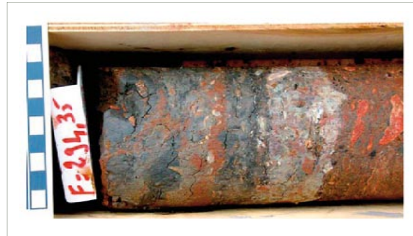
Fig. 6: Anhydrite-shale breccia in the red shale succession below the salt deposit. Well 043-A27: 294.35–294.45 m (scale bar in centimeters) | Anhydrit-Tonstein-Brekzie in der Serie roter Tonsteine im Liegenden der Steinsalzfolge. Bohrung 043-A27: 294,35–294,45 m (Maßstab in Zentimetern)
