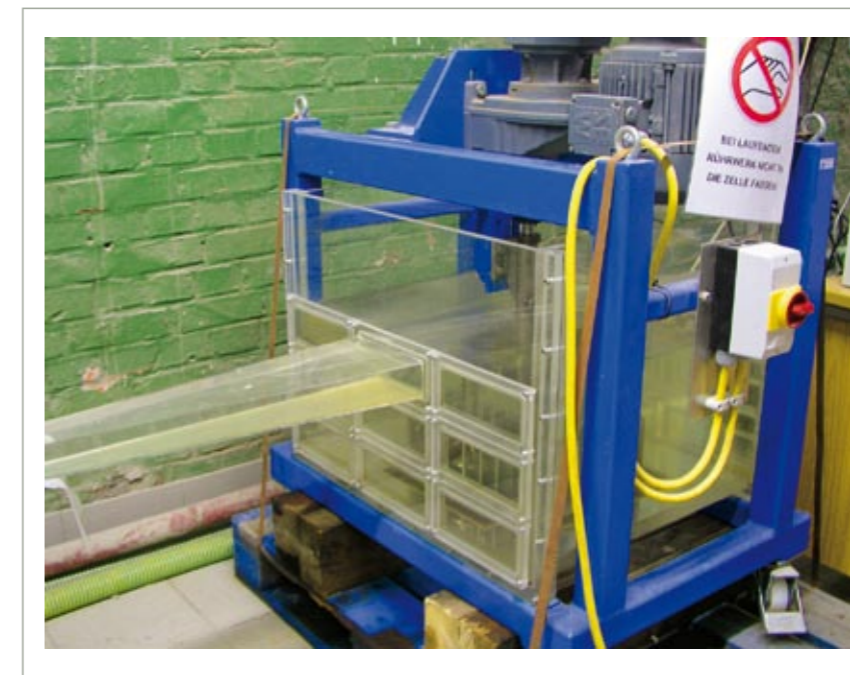
Abb. 3: Rührwerkszelle mit Einlaufdiffusor / Agitation cell with conical inflow diffuser
