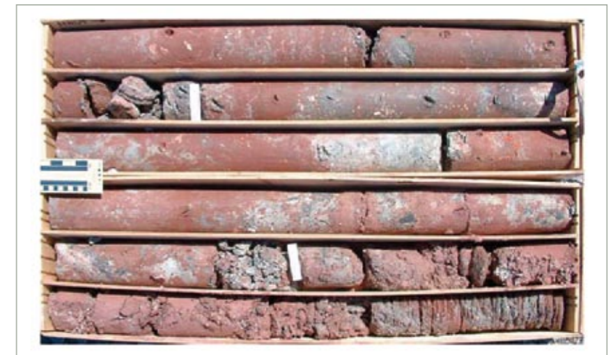
Fig. 5: Red shales on top of the salt deposit. Well 043-A27: 112.65-118.7 m (the scale bar represents centimeters and inches, respectively) | Rote Tonsteine im Hangenden der Steinsalzfolge. Bohrung 043-A27: 112,65-118,7 m (Maßstab in Zentimetern bzw. in Zoll)
