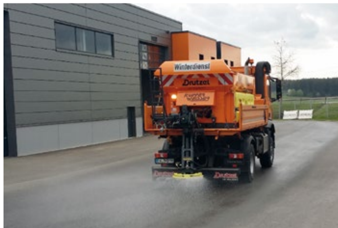
Bild: Ausbringen reiner Salzlösung über Streuteller
