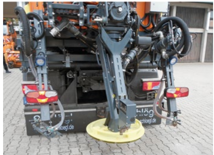
Bild : Kombinations-Streugerät mit Streuteller für Feuchtsalz und Sprühdüsen für Salzlösungen
