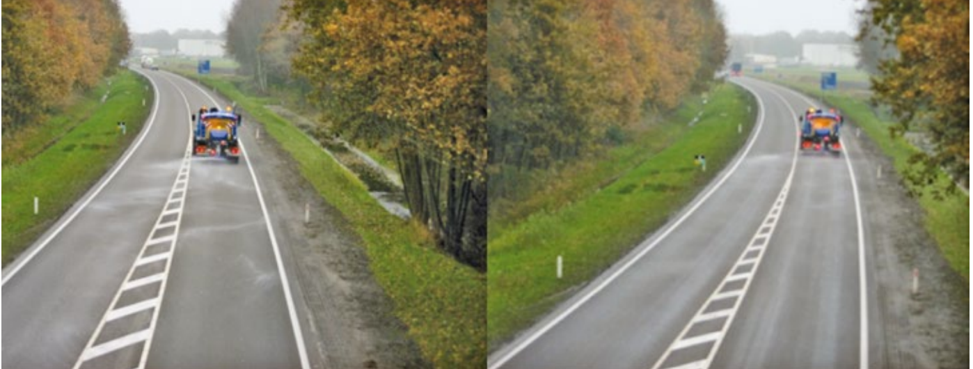
Bild: Vergleich Streubild Trockensalz und Feuchtsalz (Fotos Schmidt)
