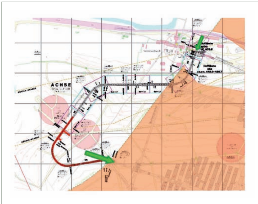
Abb.2: Stollentrasse westlich des Grubengebäudes auf der Hochschule / Drift entry west of the mining area
