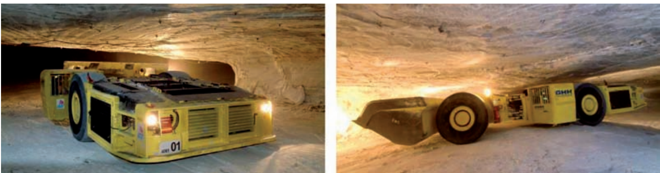
Abb. 7: Fahrlader SLP 12 unter Tage im Grubenbetrieb Hattorf-Wintershall / Scoop SLP 12 underground in the Hattorf/Wintershall mine
