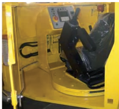
Abb. 5: Bedienstand im Fahrerhaus mit Joysticklenkung und Schwenksitz | Drivers cab with control panel, joystick power steering and rotatable driver's seat
