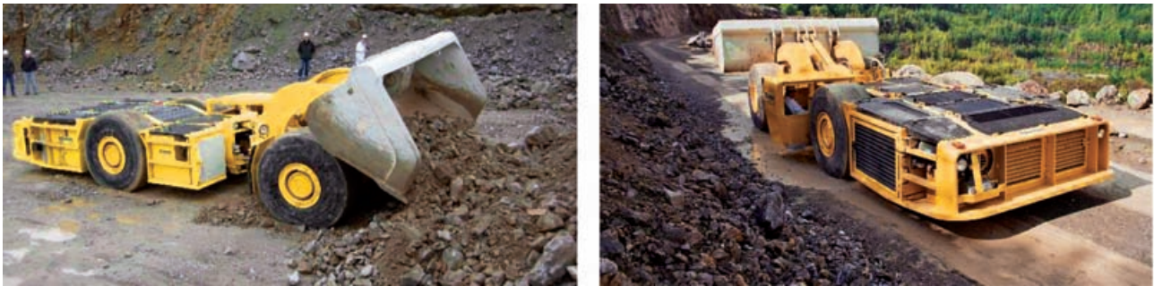
Abb. 6: Fahrlader SLP 12 im Kalksteinbruch bei Lade-Testbetrieb / Scoop SLP 12 for loading trial run in a limestone quarry
