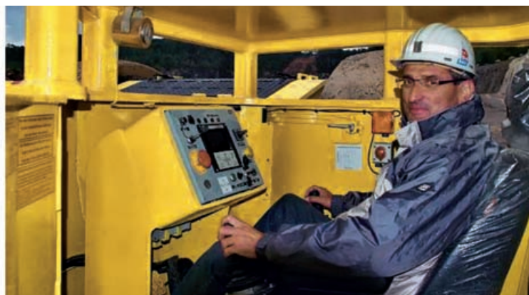
Abb. 5: Bedienstand im Fahrerhaus mit Joysticklenkung und Schwenksitz | Drivers cab with control panel, joystick power steering and rotatable driver's seat
