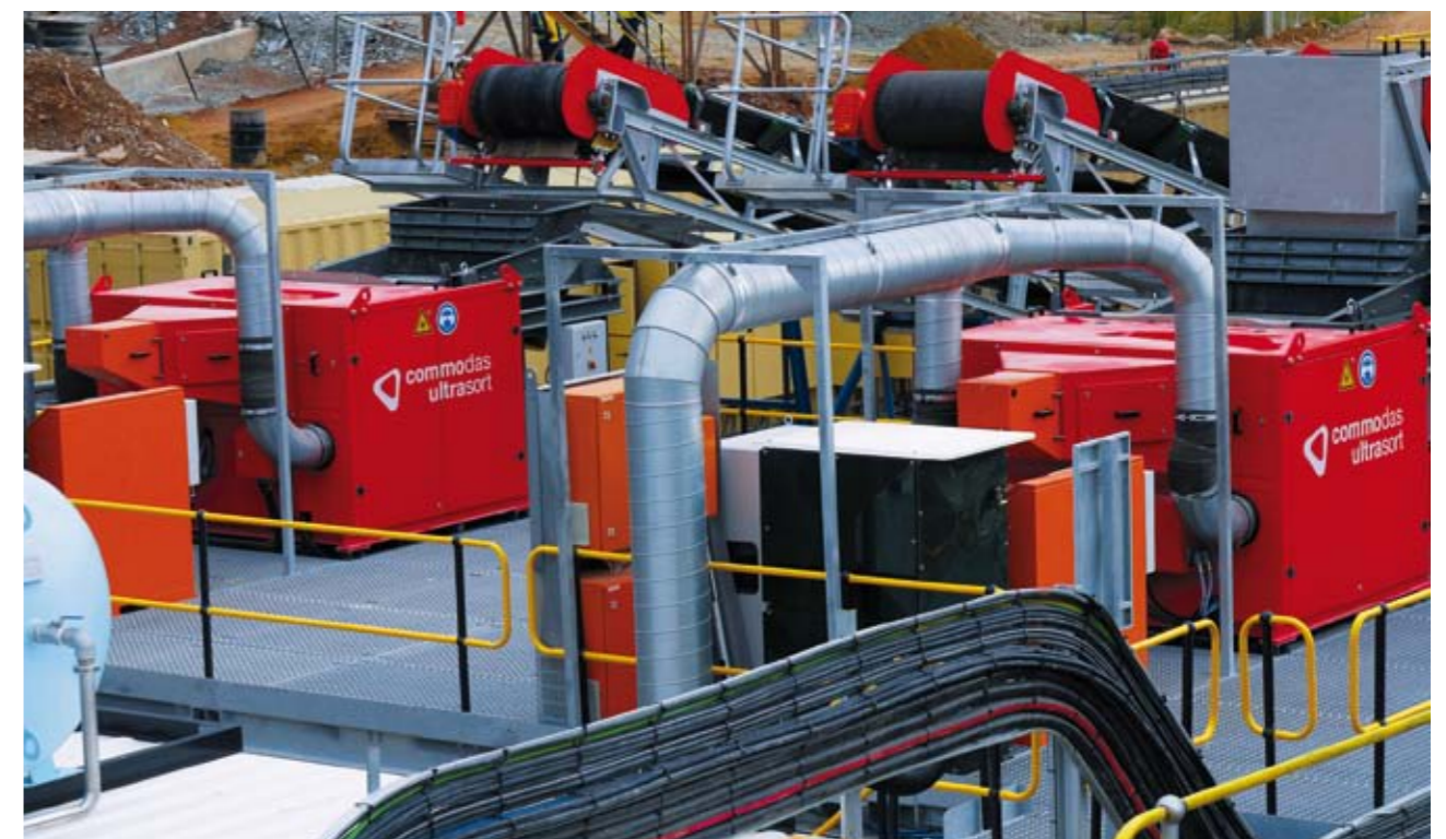
Abb. 6: Sensorbasierte Sortiereinheit / Sensor Based Sorting Module (Quelle: Tomra Sorting Solutions Mining)
