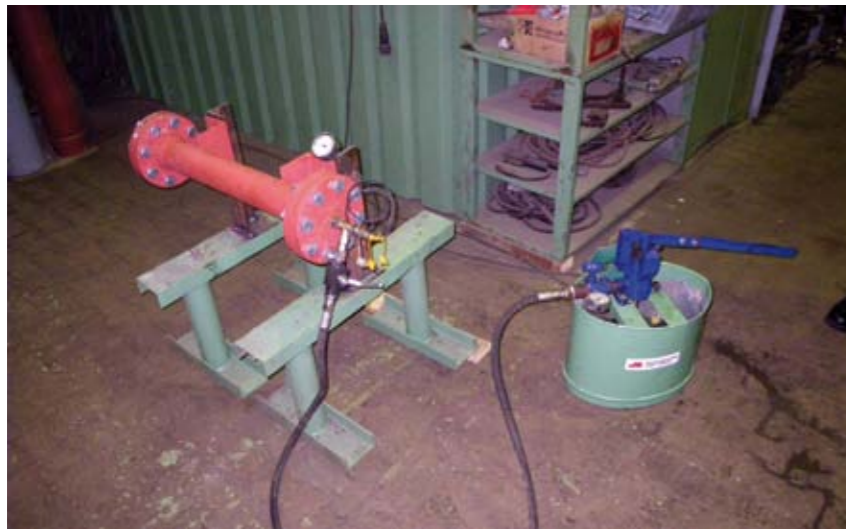
Abb. 8: Druckzylinder zum Test des Dichtungsmaterials / Impression cylinder to test the sealing material
