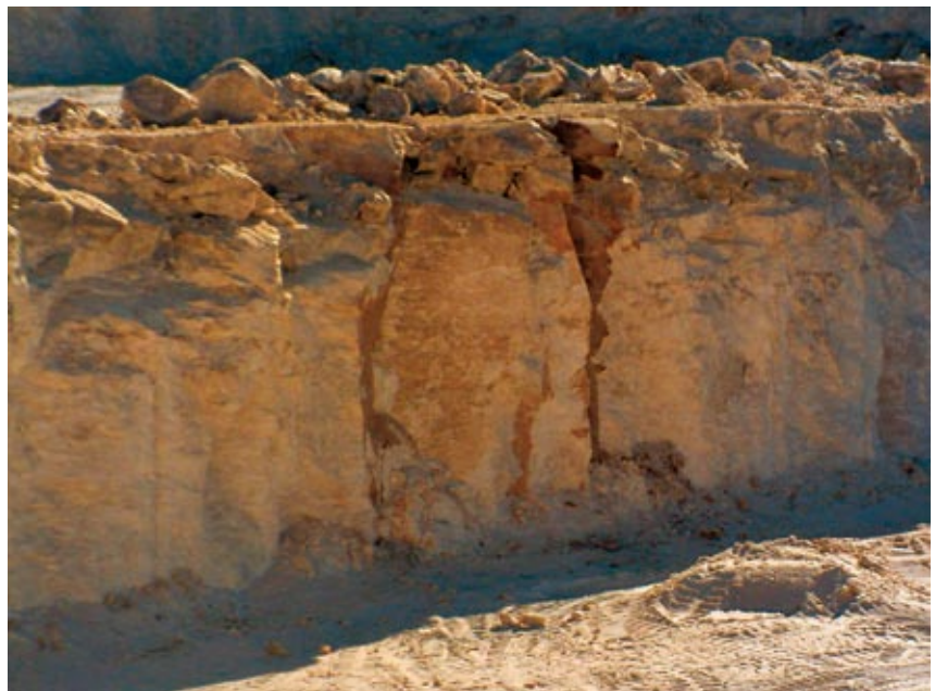
Abb. 12: Klüfte mit Tonfüllungen in der Abbaufont des Tagebaus Loberas. Foto: Verfasser / Fissure filled with clay material in the mine front of the open pit Loberas. Photo: Author
