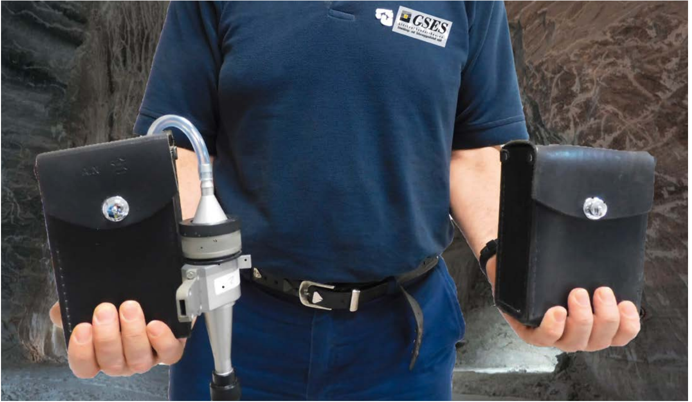
Abbildung 2: Mitarbeiter mit zwei Messgeräten zur Staubmessung für die Ermittlung von zwei Leitparametern. Foto: GSES
