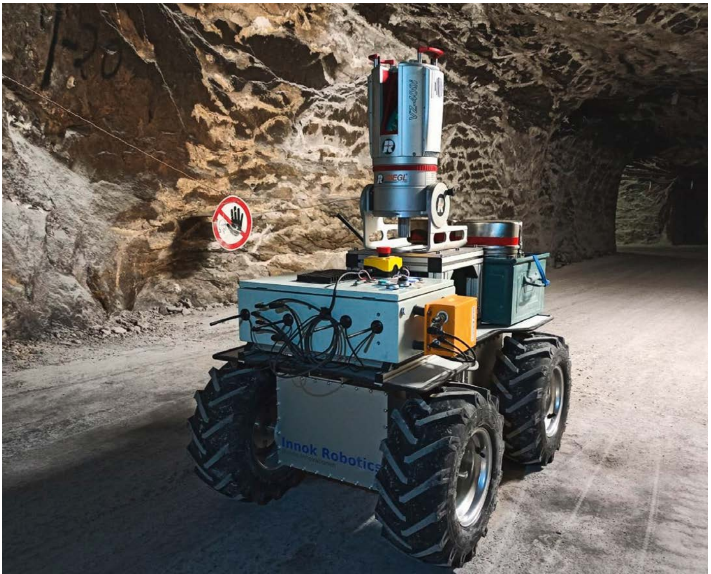
Abb. 4: Roboter-Fahrgestell der Firma Innok Robotics GmbH mit montiertem Laserscanner (Firma RIEGL GmbH) zur (teil-)automatisierten Scan-Aufnahme des untertägigen Grubengebäudes (Foto: Markscheiderei Standort Unterbreizbach, J. Nensel).
