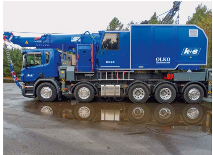
Die neueste Autoschachtwinde (ASW 3, Baujahr 2017) der Einheit Inaktive Werke; sie ist auf der Schachanlage Bergmannsseen stationiert
