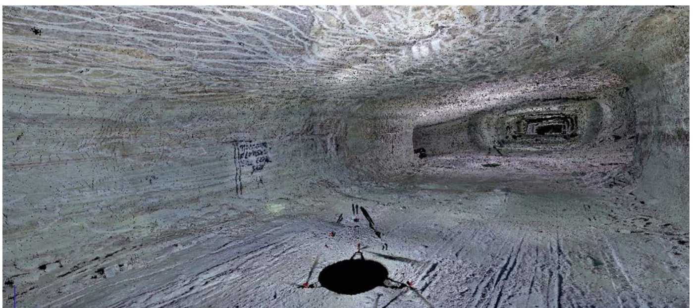
Abb. 5: Laserscan-Farbaufnahme einer Abbaustrecke des Standortes Unterbreizbach der K+S Gruppe (Quelle: Markscheiderei Standort Unterbreizbach). Aus dem Scan lässt sich die dreidimensionale Raumlage des Tonlösers Hessen ableiten und zur Modellierung heranziehen.
