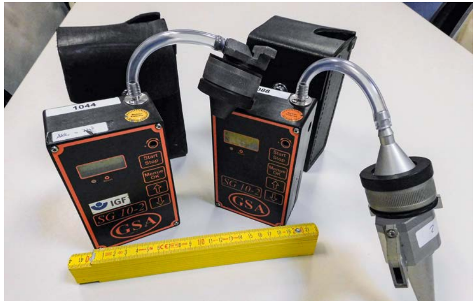
Abbildung 4 (neu): Staubmessgeräte des IGF zur Ermittlung von A- und E-Staub, Foto: GSES
