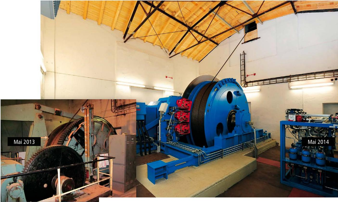
Abbildung 8: Erneuerung Förderanlage Schacht Fürstenhall – Haspel-Windenanlage
