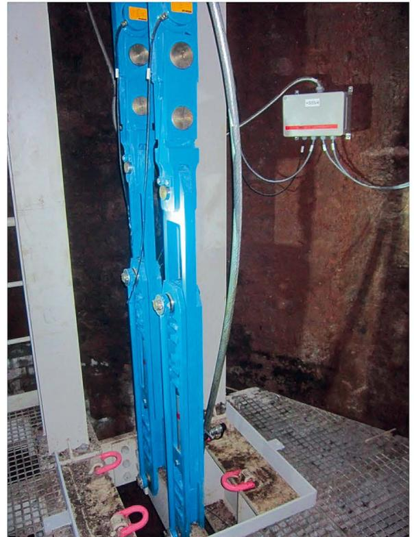
Abbildung 10: Erneuerung Förderanlage Schacht Fürstenhall – Korbhaltevorrichtung und hydraulische Spannvorrichtung für die Führungsseile
