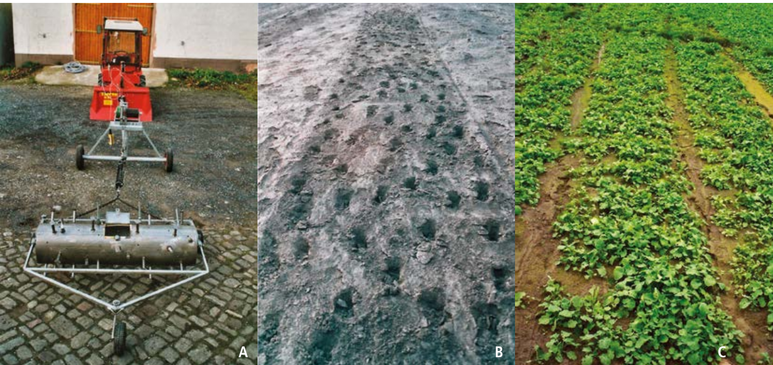
Abbildung 6: Technische Entwicklung A. Haldenigel mit Seilwinde, B. Laufprofil des Haldenigels, C. Auflaufende Saat (Raps) innerhalb des Laufprofils
