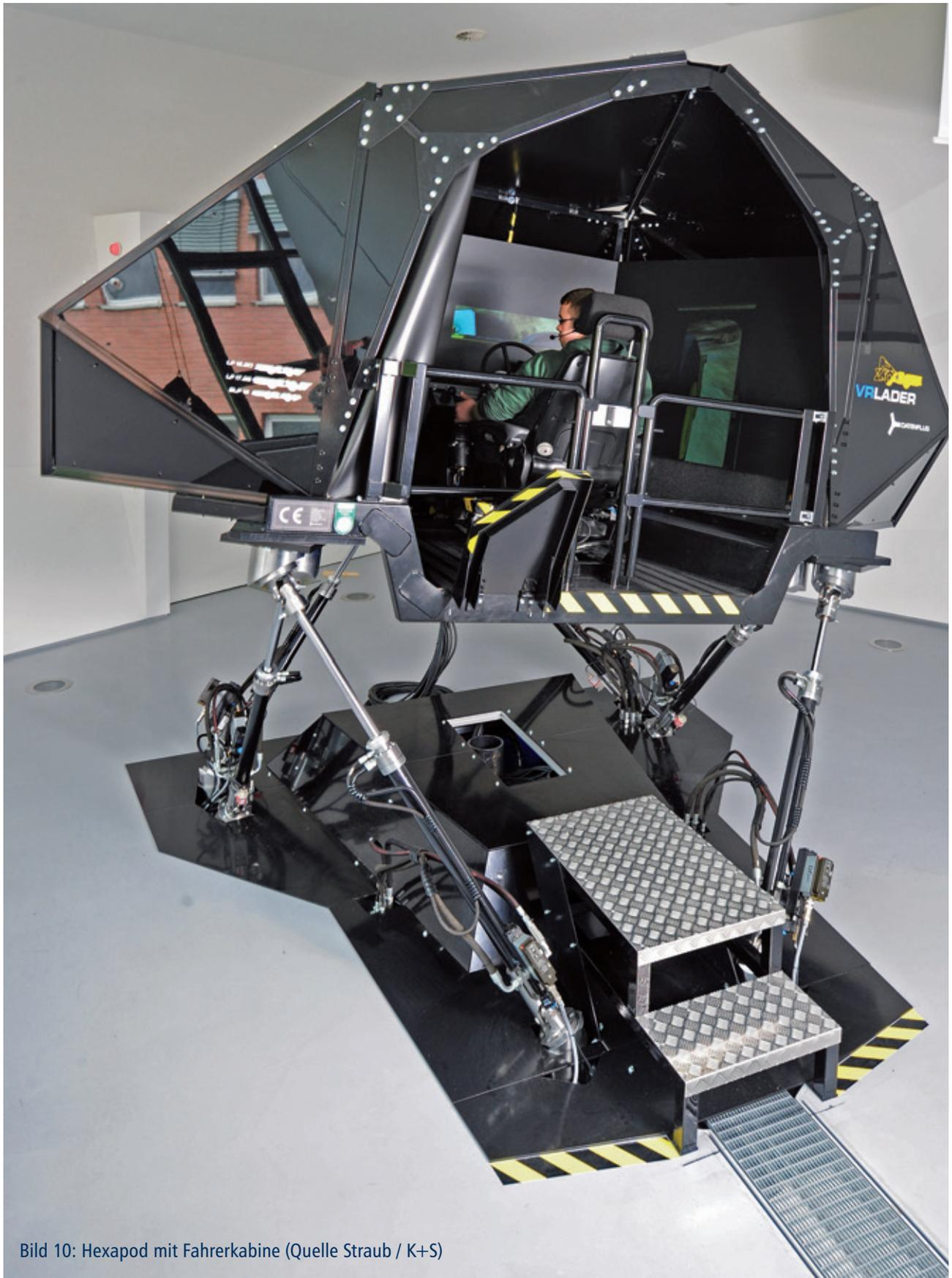
Bild 10: Hexapod mit Fahrerkabine (Quelle Straub / K+S)
