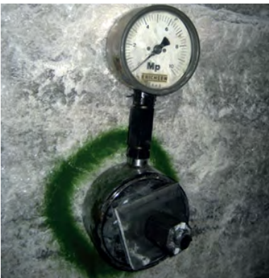
Versuchsanordnung zur Messung der Vorspannkraft
