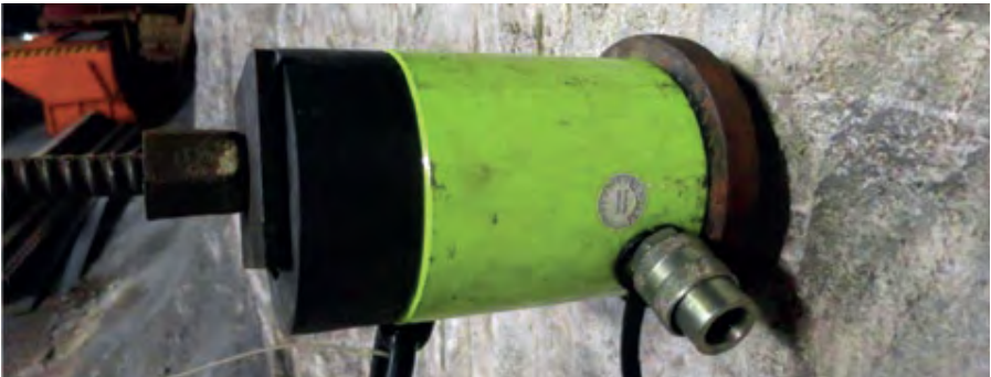
Ankerzugversuch am Stoß
