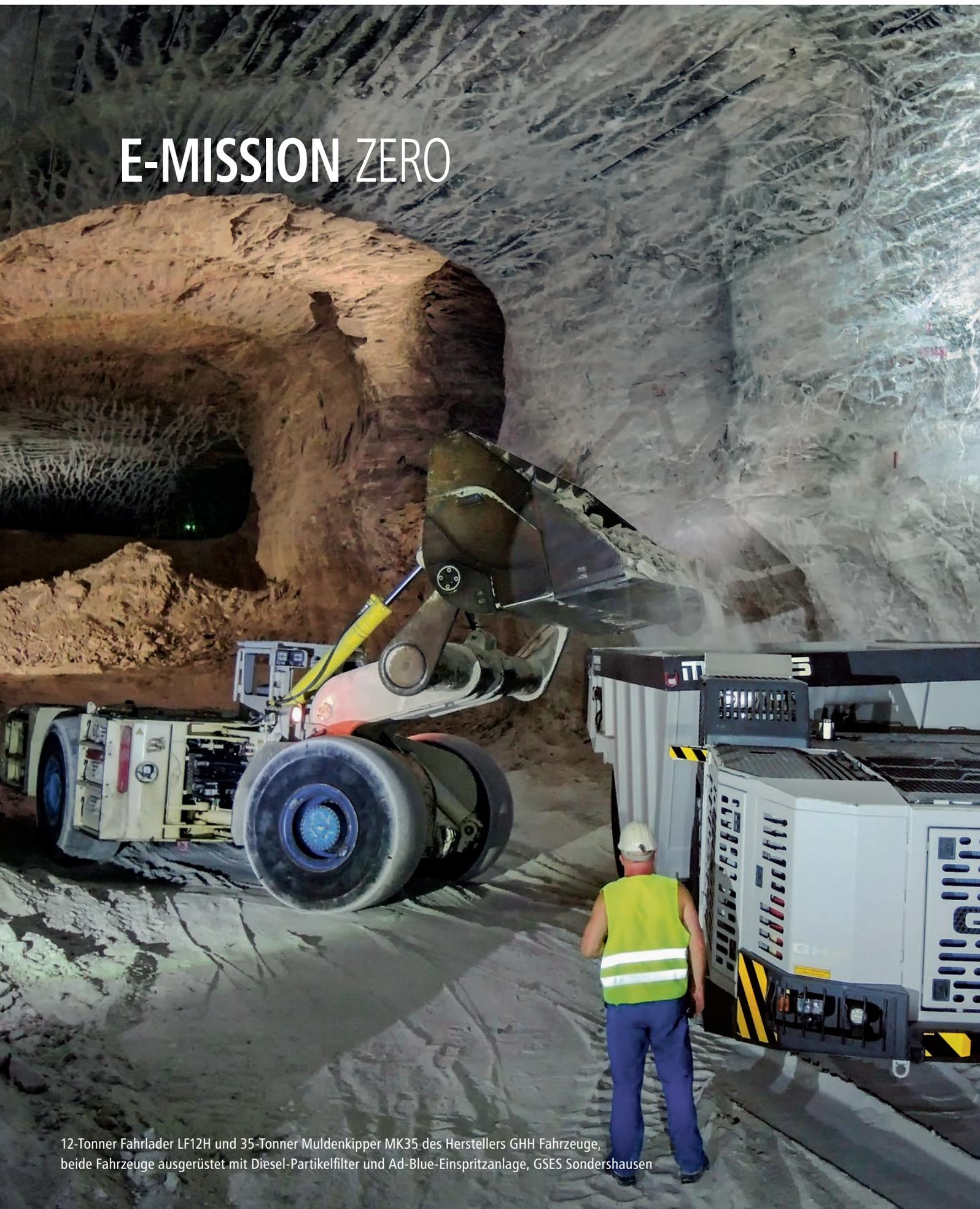
12-Tonner Fahrlader LF12H und 35-Tonner Muldenkipper MK35 des Herstellers GHH Fahrzeuge, beide Fahrzeuge ausgerüstet mit Diesel-Partikelfilter und Ad-Blue-Einspritzanlage, GSES Sondershausen
