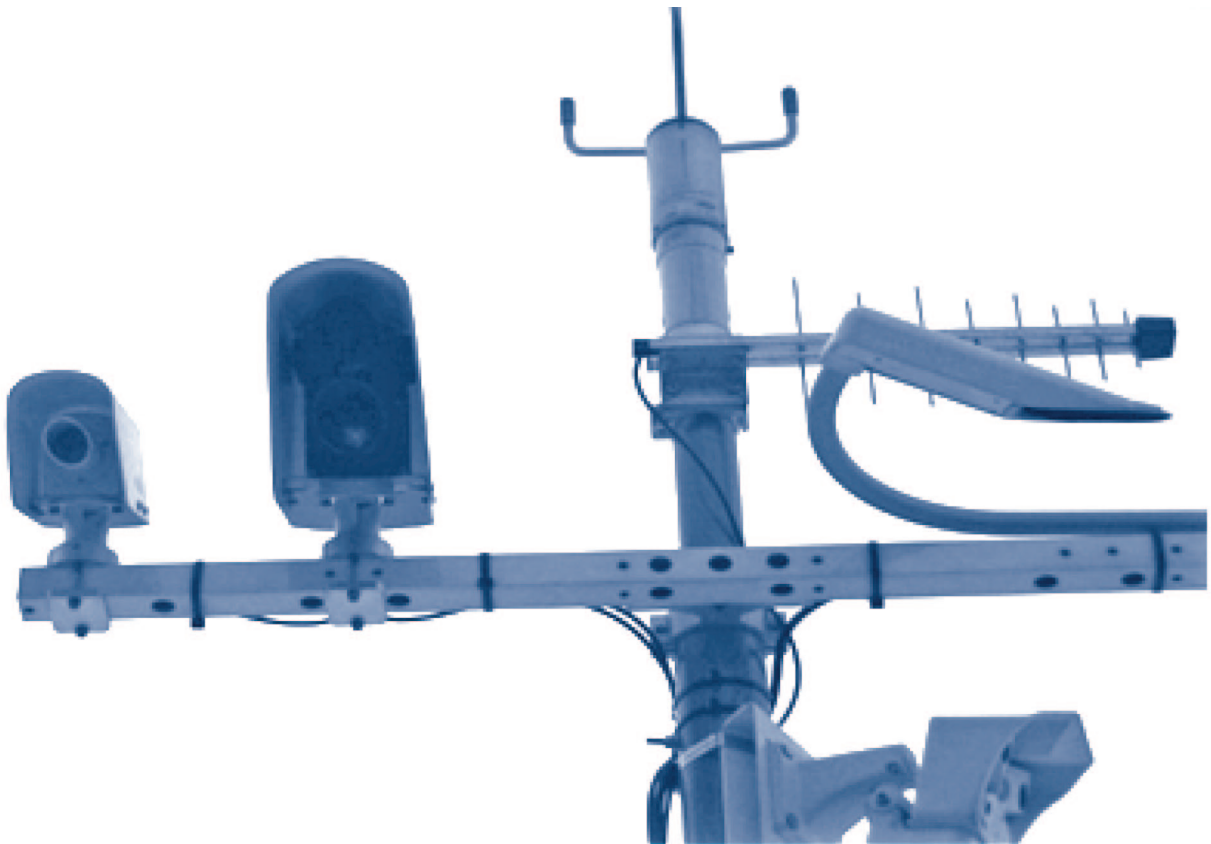
Bild 2: Messgeräte zur berührungslosen Erfassung von Fahrbahnzustand und -temperatur (links) an einem Mast einer Glättemeldeanlage mit weiteren Sensoren für die Erfassung atmosphärischer Parameter, Quelle: [HOLLDORB et al 2011]
