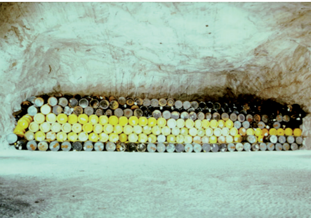
Abb. 7: Einlagerung von schwachradioaktiven Abfällen – Stapeltechnik (liegend) / Disposal of low-level waste (horizontal stack)
