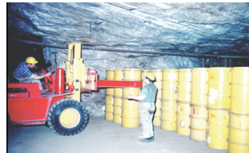
Abb. 6: Einlagerung von schwachradioaktiven Abfällen – Stapeltechnik (stehend) / Disposal of low-level waste (vertical stack)
