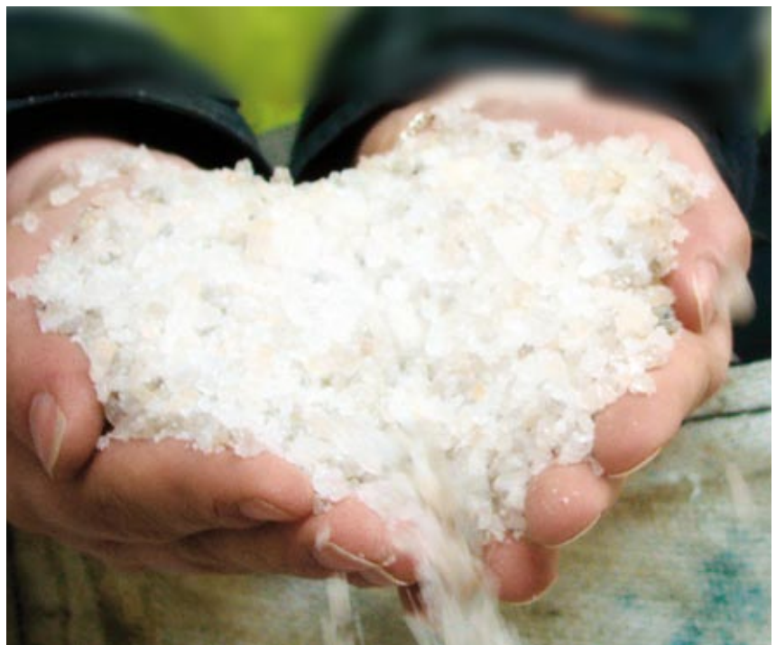
Streusalz für den Straßenwinterdienst, hier: Korngröße 0-5 mm / De-icing Salt with a Particle Size of 0-5 mm
